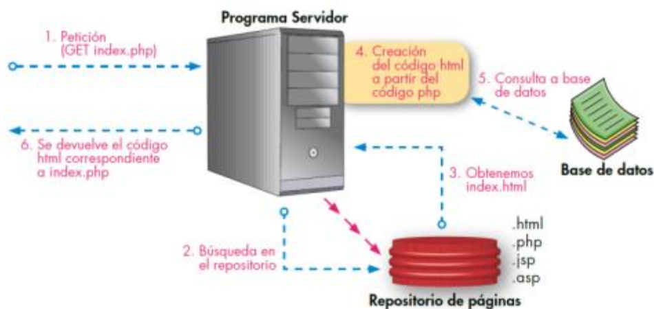
Ilustración N° 12 Esquema de funcionamiento PHP
