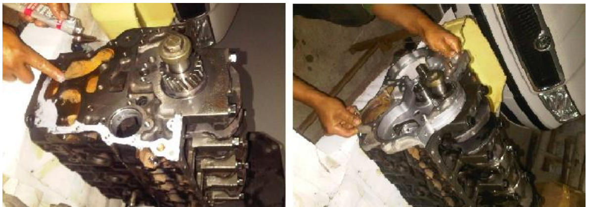
Figura 45. Colocación de silicón en la distribución
