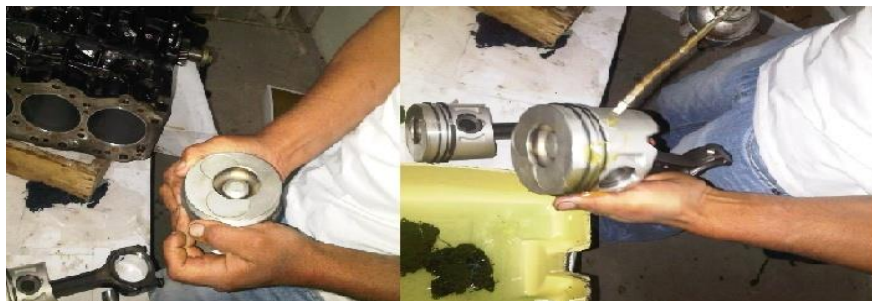
Figura 42. Mojando los cilindros de aceite
