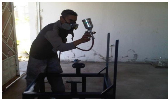
Figura 50 Pintado de la estructura
