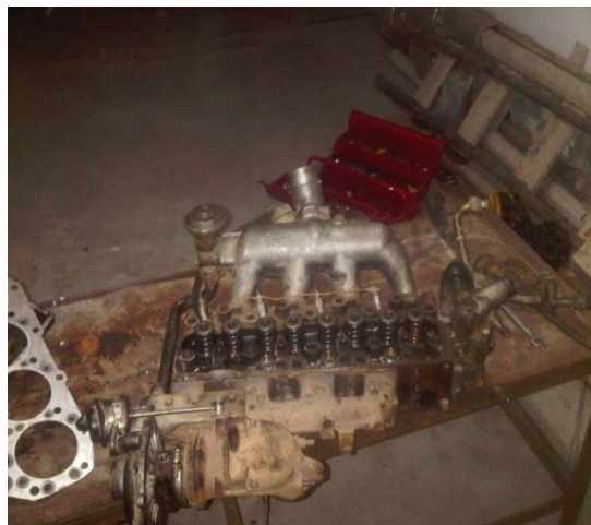
Figura 34. Desmontaje del cabezote
