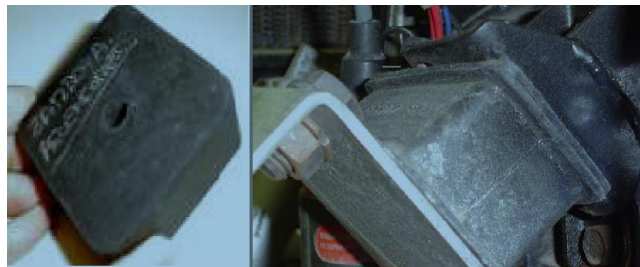
Figura 55. Aisladores de caucho utilizado en motores
