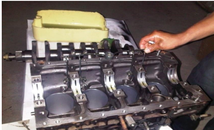
Figura 38. Instalación de pulverizadores de aceite
