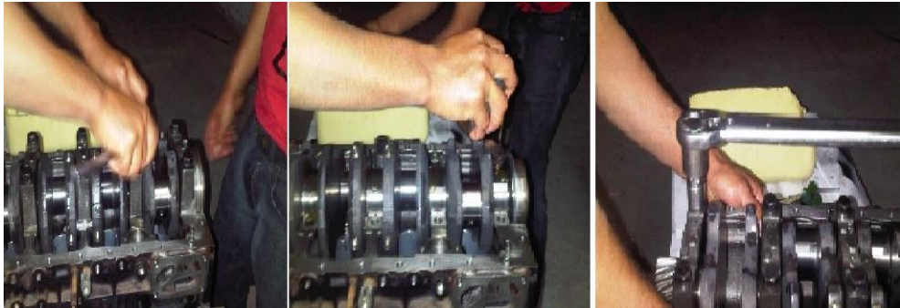
Figura 41. Comprobación de la holgura en la bancada
