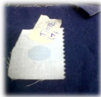
Fig. 49: Denim Prueba de Frote.
