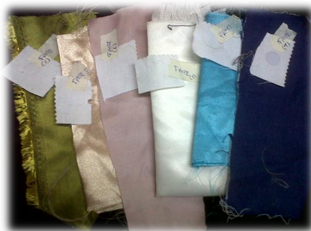
Fig. 47: Muestras sometidas al Frote.
