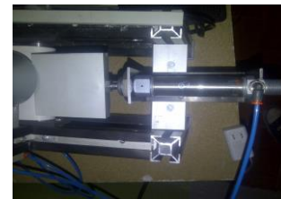
Figura 1 Cilindro neumático para el ingreso de piezas
