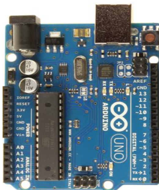
Figura 41. Placa ARDUINO UNO Fuente: Guía de usuario de Arduino
