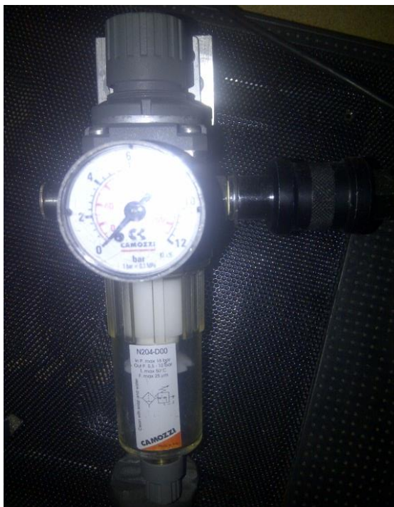
Figura 32. Dispositivo que permite la purificación de aire (Unidad de mantenimiento) Fuente: Autor
