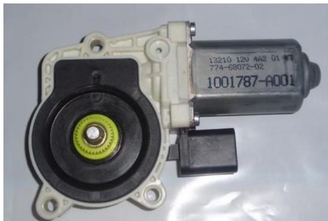
Figura 35. Motor Reductor empleado Fuente: Autor
