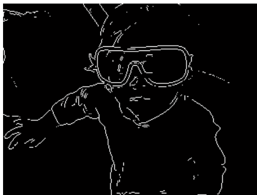
Figura 24. Utilizando el Método sobel Fuente: Autor
