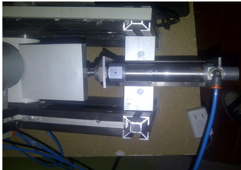
Figura 31 Cilindro neumático simple efecto (metal work) Fuente : Autor
