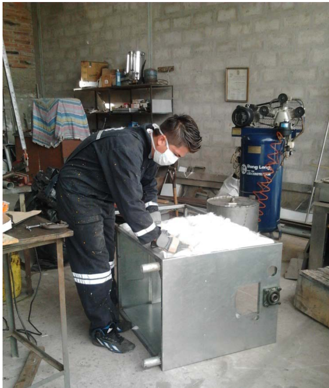
FIGURA 4.9: Colocación de la lana de vidrio para el blindaje. 134
