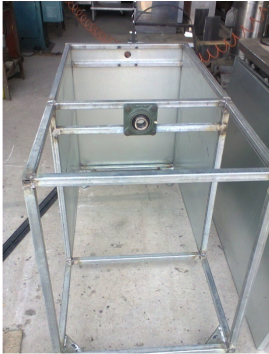
FIGURA 4.7: Estructura de tubo antes de recubrir. 132
