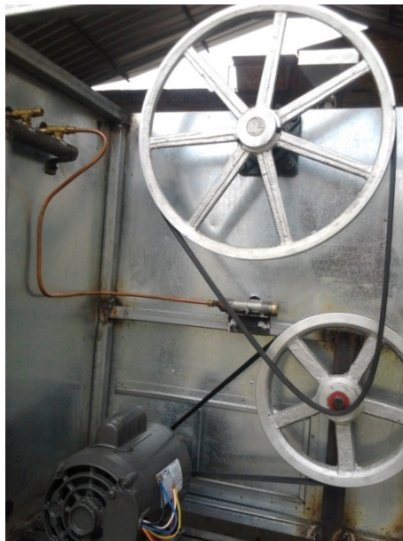
FIGURA 4.12: Juego de poleas y bandas para la reducción de velocidad. 139
