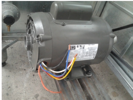
FIGURA 4.11: Motor marca WEG 1HP 110V-220V. 138
