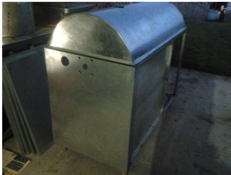
FIGURA 4.8: Cubierta de la máquina. 133
