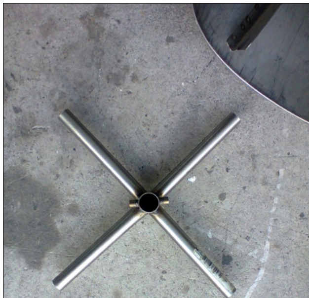
FIGURA 4.5: Volante de sujeción del eje contra el tambor. 130
