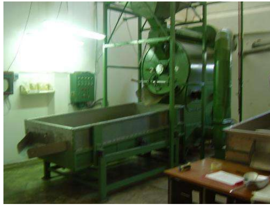
FIGURA 1.3: Tostadora industrial de maní. 11
