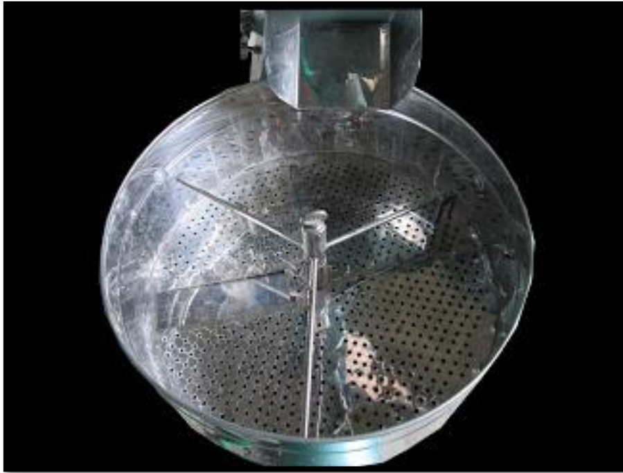
Figura 2. 4 Mecanismo de enfriamiento Tostadora de café
