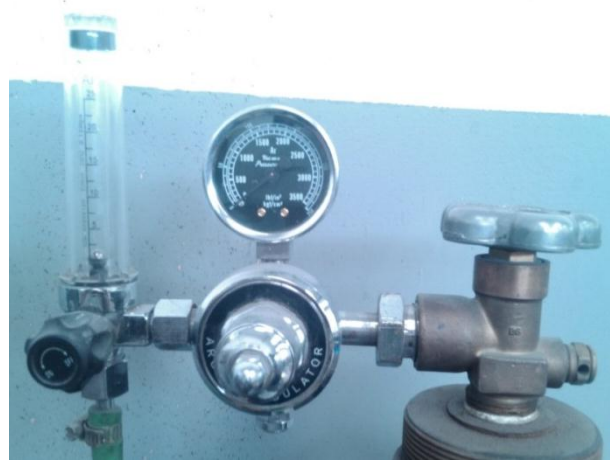
Figura 26 Reguladores de presión o Manorreductores.
