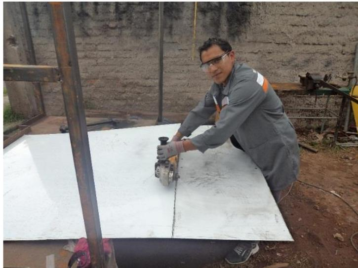
Corte para la carcasa de la máquina
