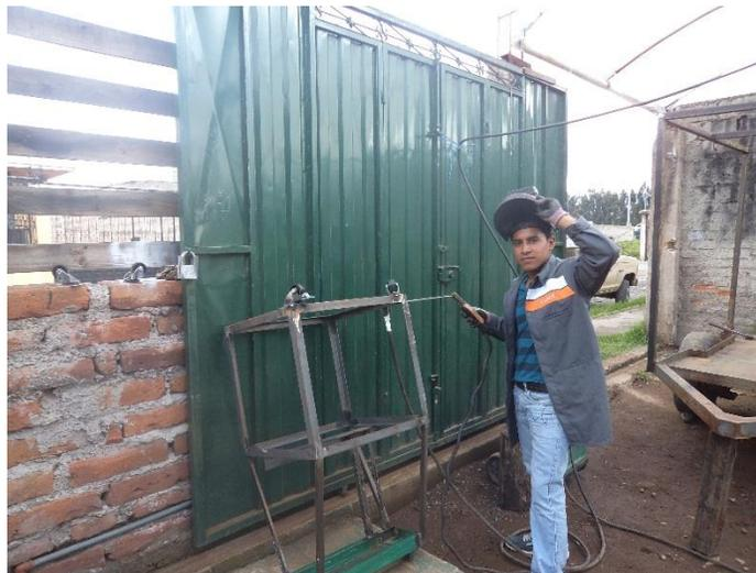
Suelda de la estructura de máquina rebanadora
