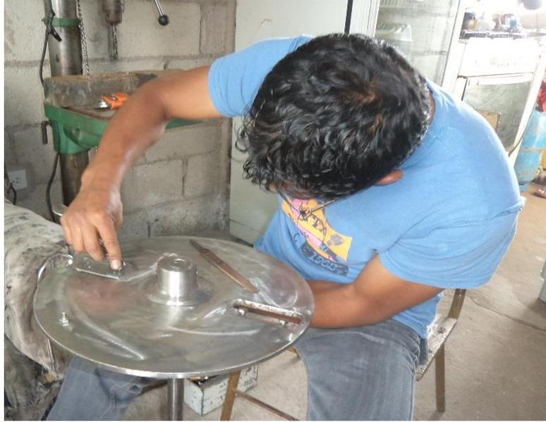
Montaje del disco de corte en el eje
