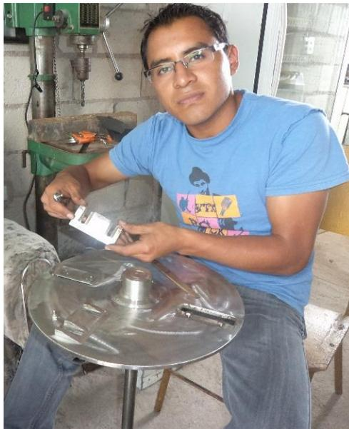
Montaje de las cuchillas en el disco de corte
