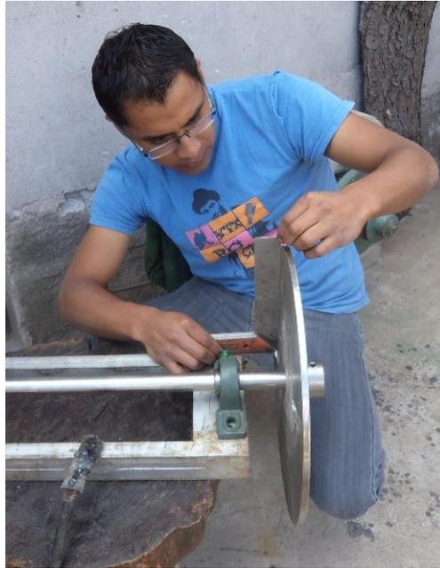
Alineación y medición del disco de corte
