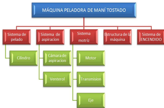
Figura 7: Máquina peladora de maní y partes que la conforman Fuente: Autor
