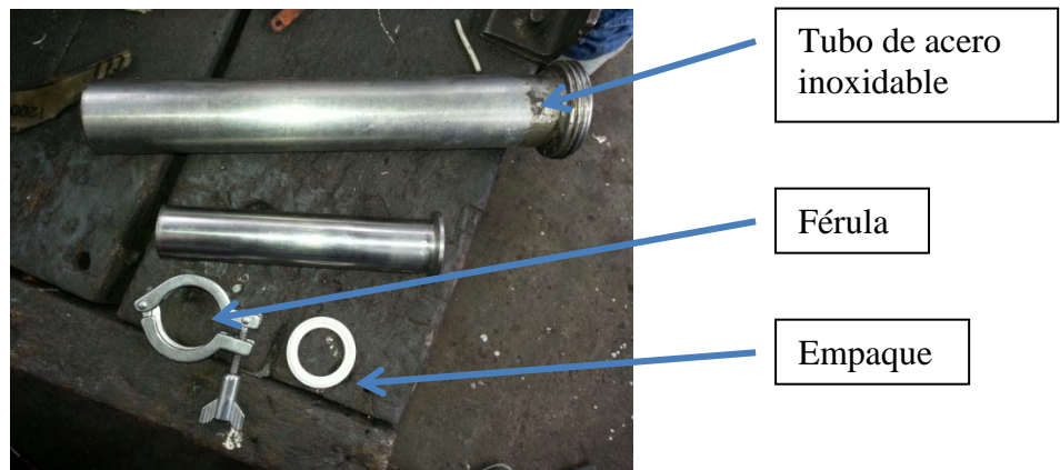
FIGURA 55. Elementos a ser instalados en el Control de Nivel
