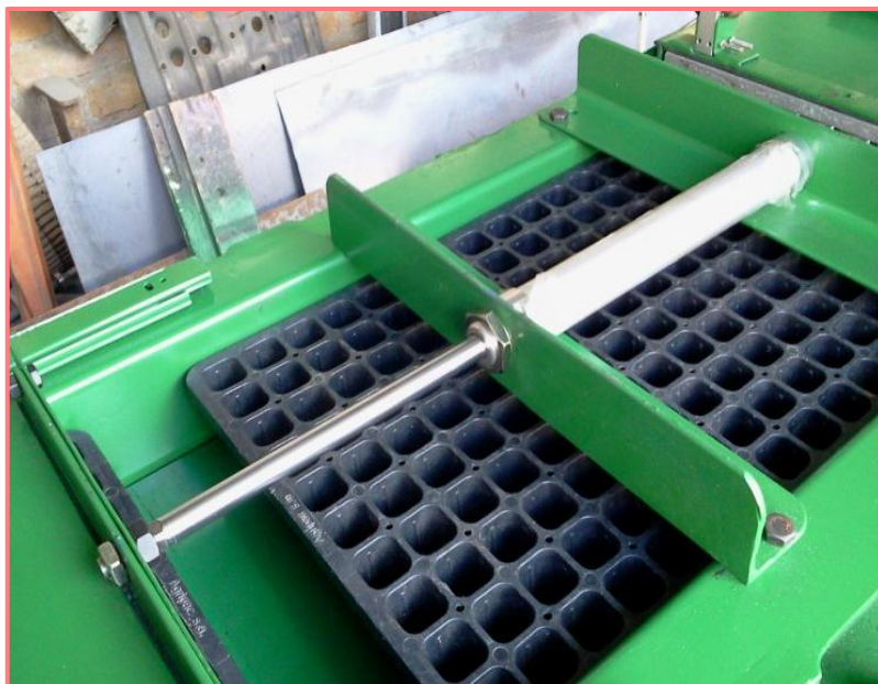
FIGURA 2.13 Cilindro neumático para la apertura y cierre de la boca de las tolvas
