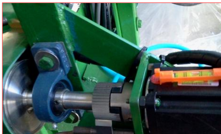
FIGURA 4.7 Acople de transmisión de movimiento del motor de la banda transportadora
