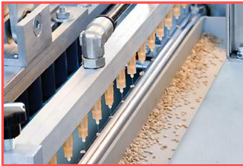
FIGURA 1.15 Unidad de siembra de agujas para utilizar semillas en muy poca cantidad (Línea de paso TO55.S)
