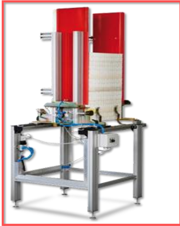
FIGURA 1.14 Desapilador de bandejas por gravedad de plástico rígido muy pesado Fuente: (Macchine OrtoFloro Vivaismo Green, 1968)
