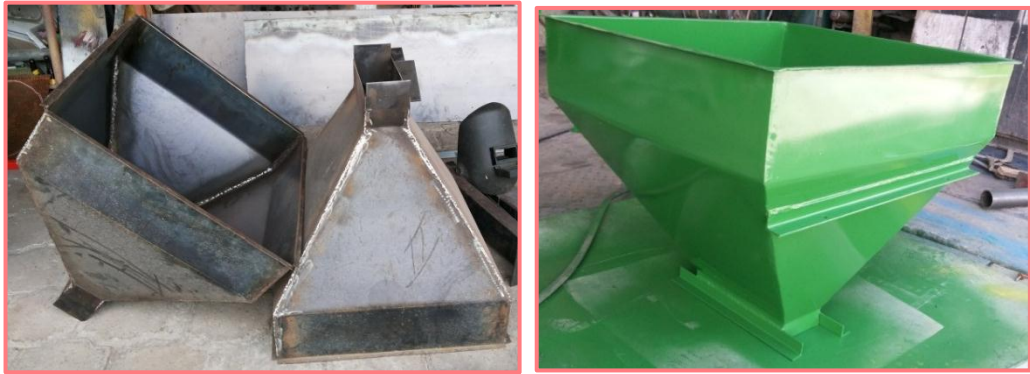
FIGURA 3.2 Construcción de las tolvas
