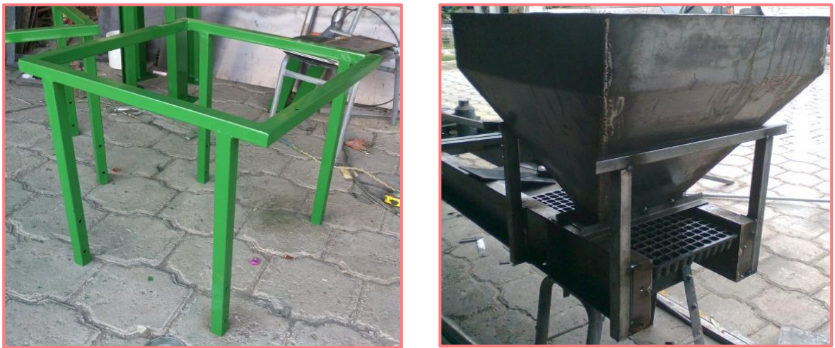
FIGURA 3.3 Construcción de la estructura de soporte de las tolvas
