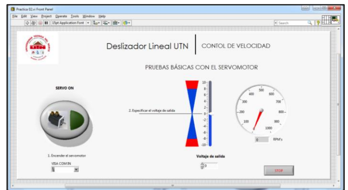
Fig. 5. Panel Frontal – Control de velocidad.
