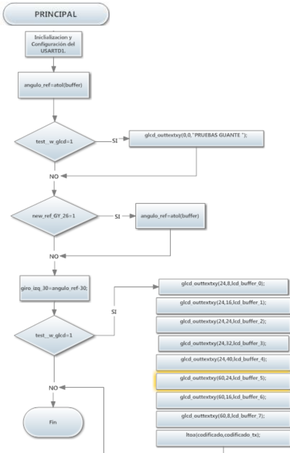
Fig. 3.28 - Flujograma del programa principal (continuación) del XMega128A1
