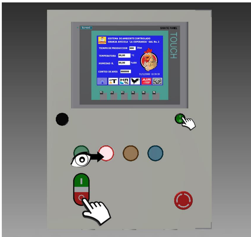
Ilustración 8.-Procedimiento Apagado del Sistema
