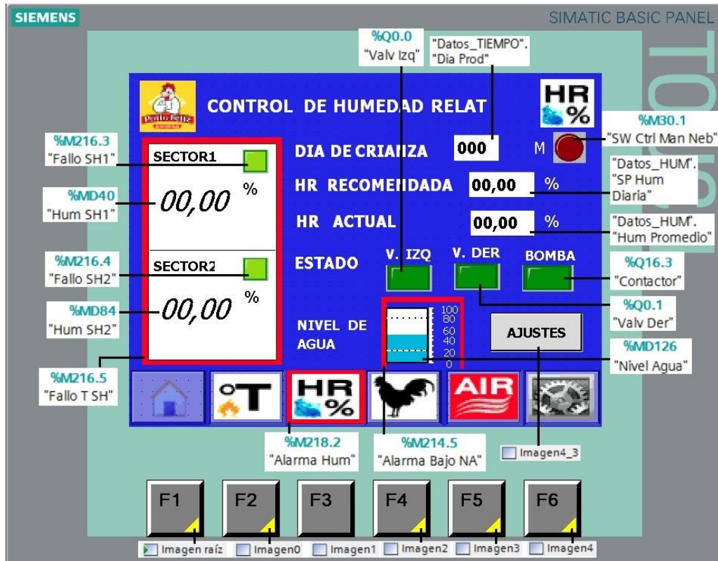
Imagen 1 – Pantalla Sistema de Control de Humedad
