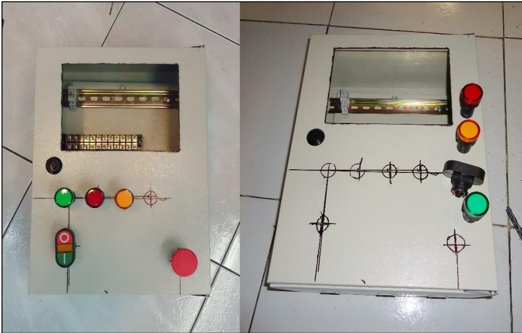
Figura 51.-Ubicación y Señalización Pre-perforado
