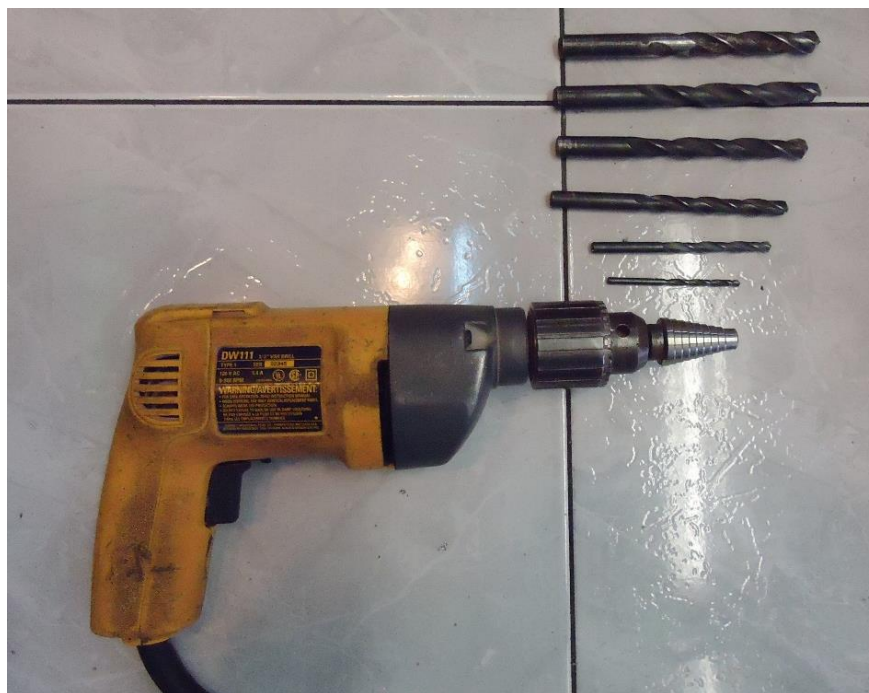
Figura 50.- Herramientas de Perforado Caja Eléctrica
