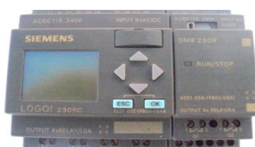
Figura 1. Controlador Lógico Programable PLC de marca SIEMENS
