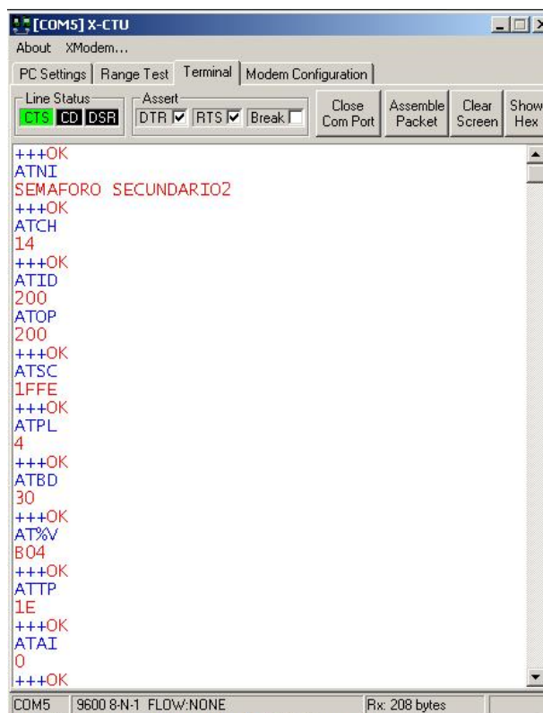
Figura 87. Comandos AT y respuestas del nodo
