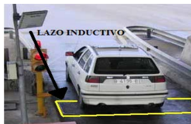
Figura 9. Aplicación del sensor de lazo inductivo en peajes
