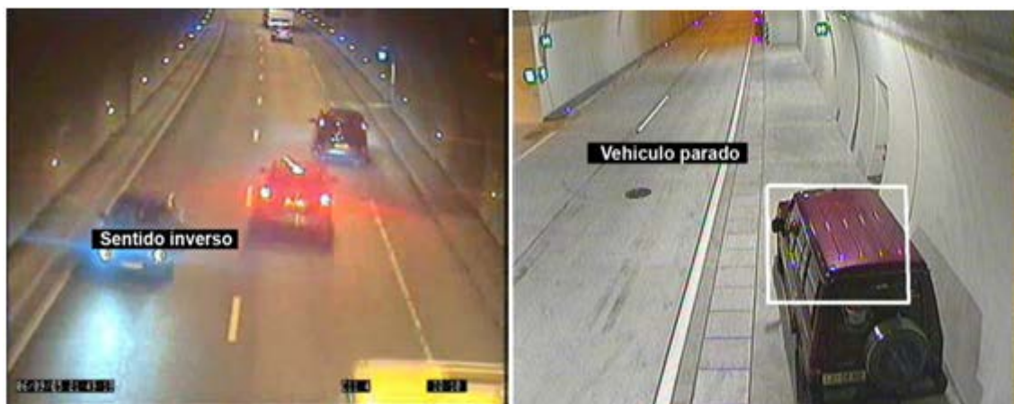
Figura 12. Imágenes de un Sistema de Procesamiento de Imágenes de Video
