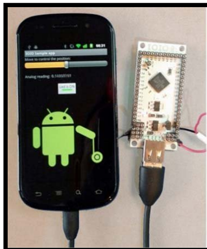
Figura 5. Conexión de la placa IOIO con el dispositivo Android mediante el cable USB
