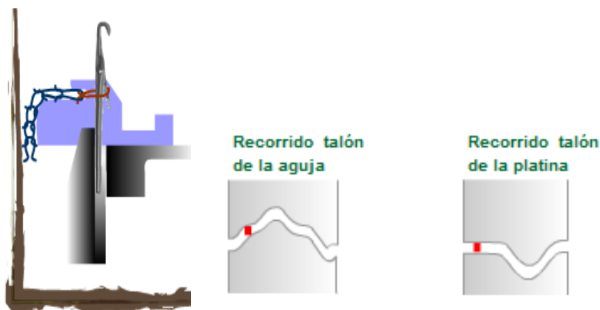
Gráfico 1.17 Posición de malla cargada
