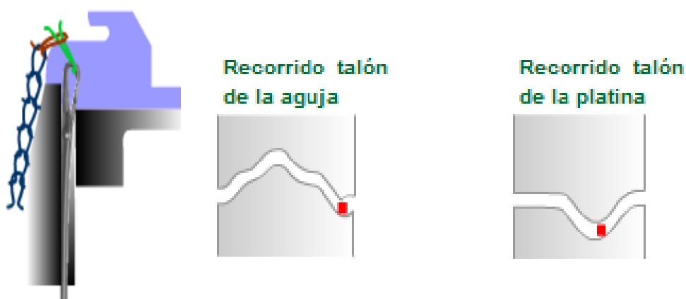
Gráfico 1.20 Posición de desprendimiento de la malla
