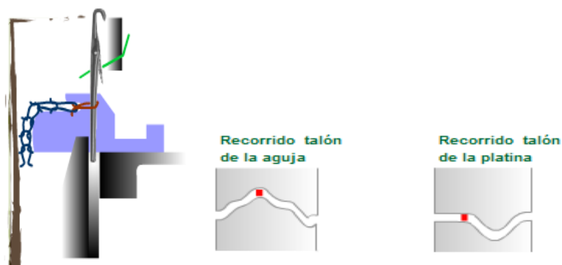
Gráfico 1.18 Posición de máxima subida
