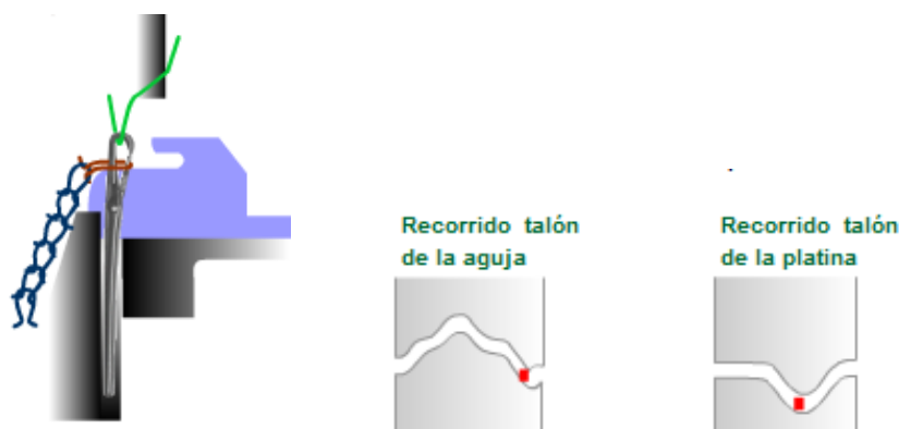
Gráfico 1.19 Posición de formación de la malla
