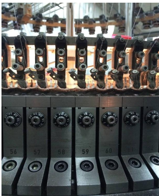
Gráfico 1.6 Máquina circular con sus cerrojos
