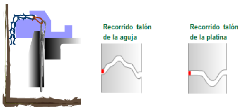
Gráfico1.16 Posición inicial para la formación de la malla
