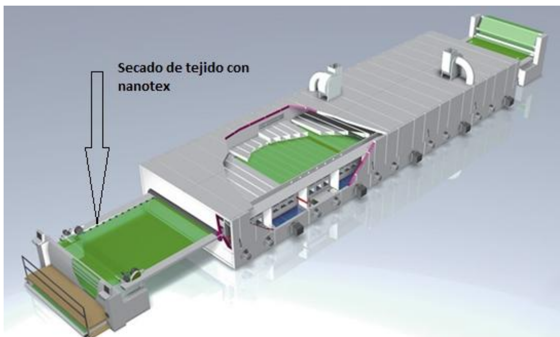
Gráfico 4.14 Proceso de secado del tejido plano
