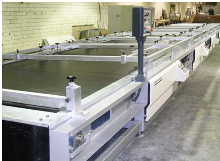
Gráfico 4.15 Mesa para aplicación por serigrafía plana
