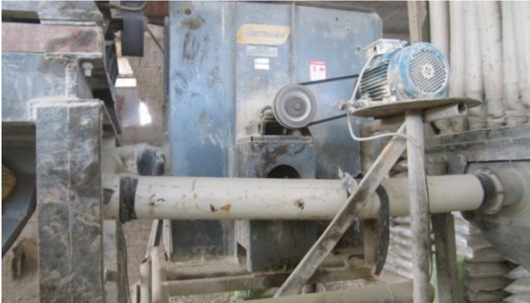
Molino de martillos para triturar el mineral
