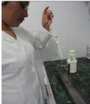
**Foto 14.** Adición de la muestra para la prueba de viscosidad. UTN, 2010.
