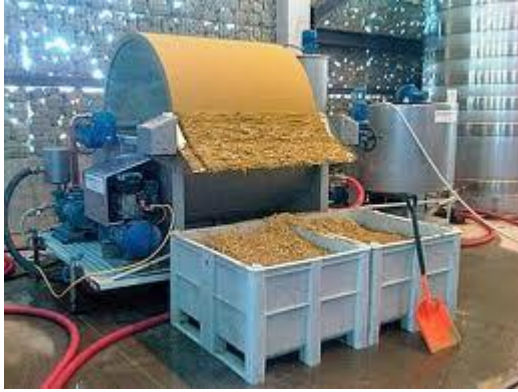
Tanque de vacío
