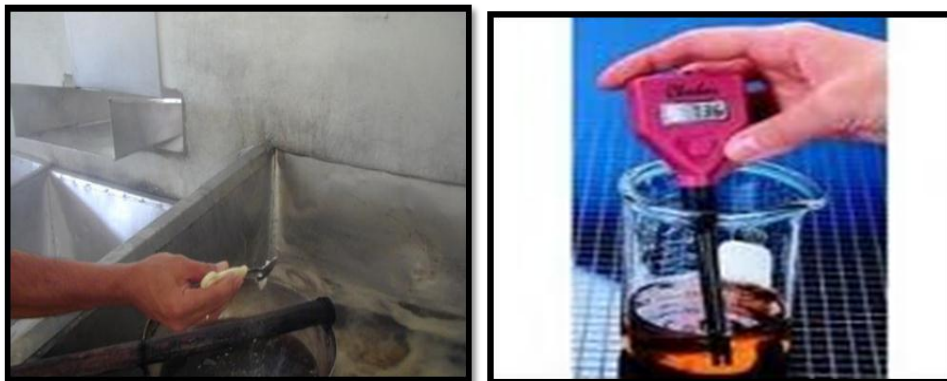
Figura 27. Ajuste y medición del pH
