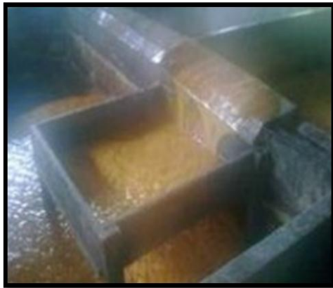
Figura 33. Cristalización del azúcar orgánico
