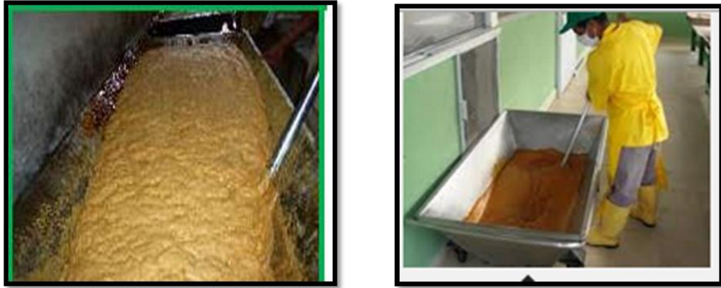
Figura 29. Punteo y batido de la panela
