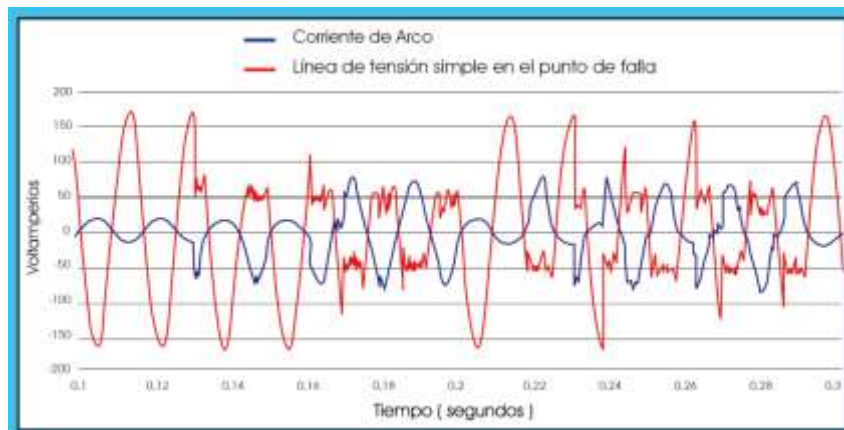
Voltaje y corriente en una falla fase-fase
