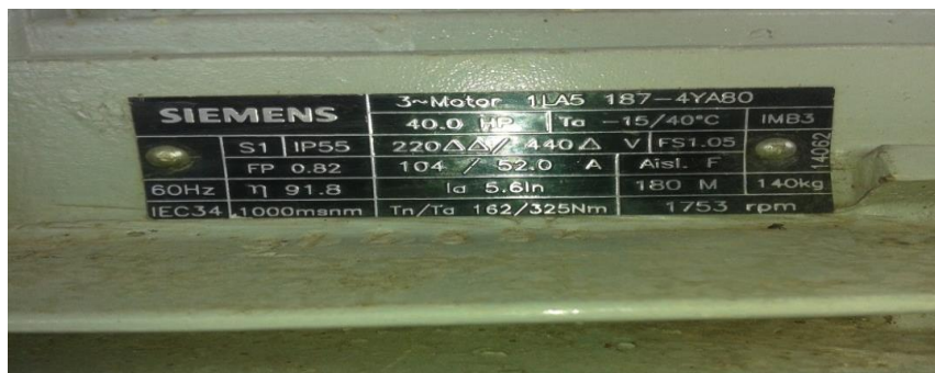
Placa de motor 40 HP SIEMENS.
