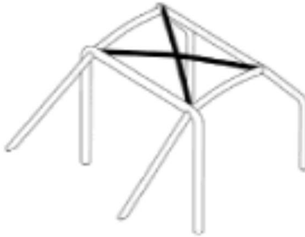
Figura 2.13. Refuerzo del techo.
