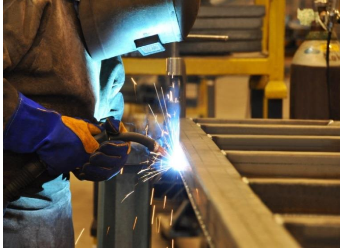
Figura 2.16. Soldadura MIG en estructura
