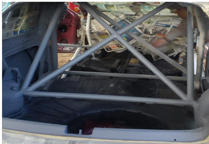
Figura 4.50 Aplicación de fondo de relleno.
