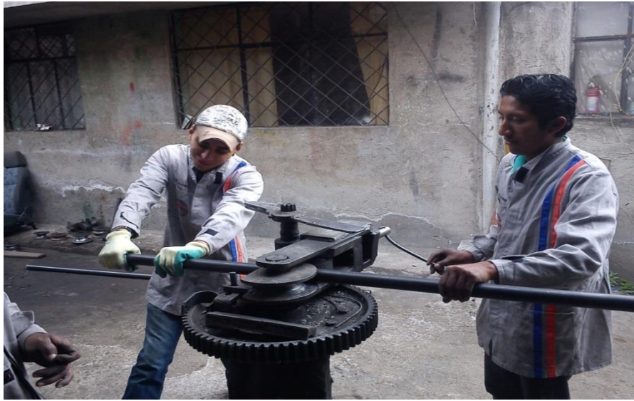
Figura 4.37. Doblado del acero.
