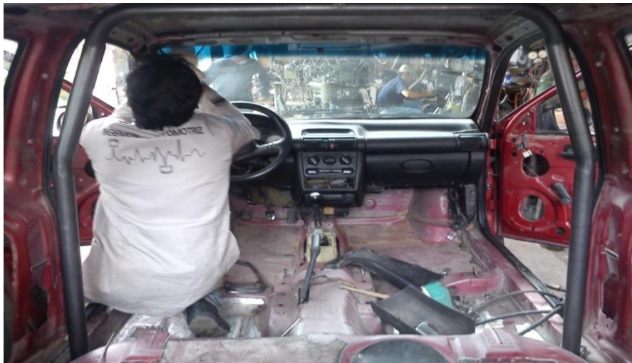
Figura 4.36. Colocación del arco secundario.
