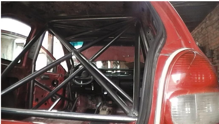
Figura 4.44. Aspecto final en soldadura.
