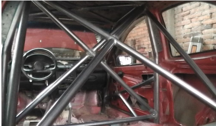
Figura 4.45. Resultado final de soldadura.
