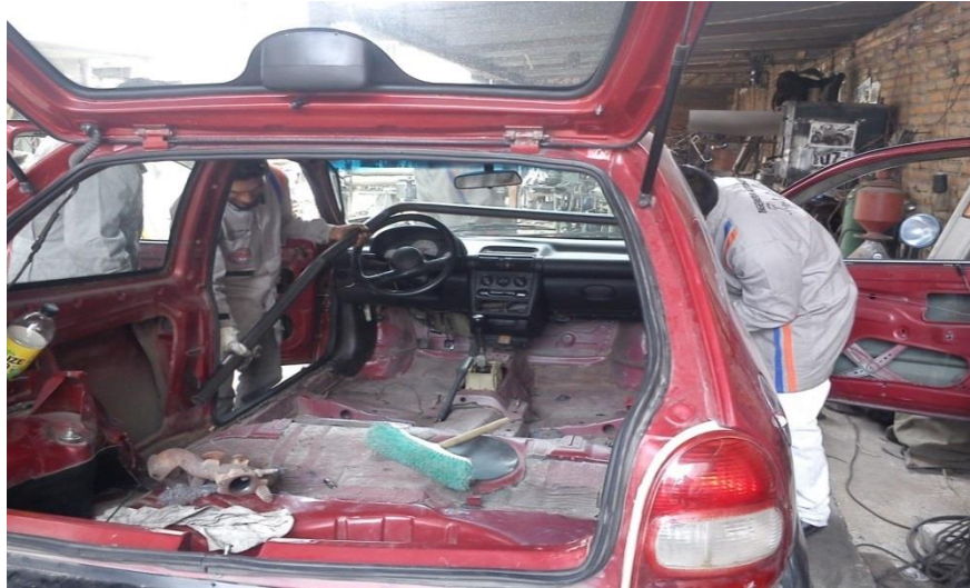
Figura 4.35. Colocación del arco principal.
