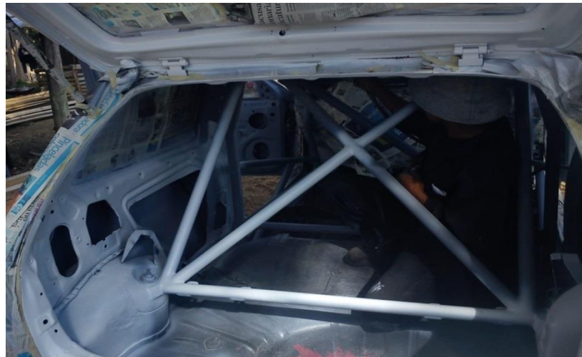
Figura 4.52 Segunda aplicación de capa de pintura.
