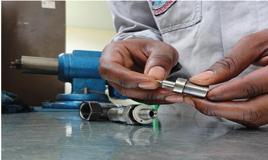
Figura 4.107. Inyector 1 Introduciendo aguja en la tobera
