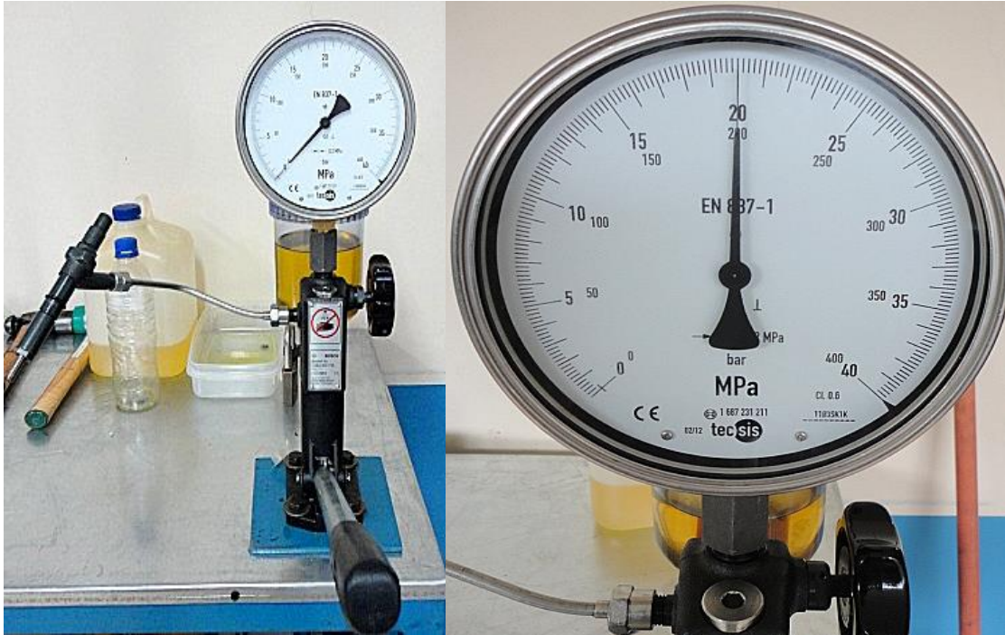
Figura 4.42. Inyector 4 Prueba de presión de apertura
