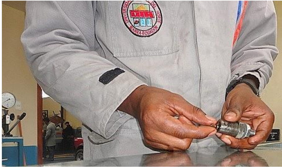
Figura 4.61. Inyector 4 Introduciendo varilla de empuje
