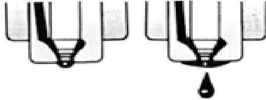
Figura 2.11. Goteo por el Inyector Fuente: S.N Mecánica Diesel, (2010)
