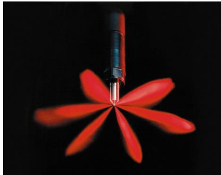
Figura 2.3. Inyector con 6 chorros.
