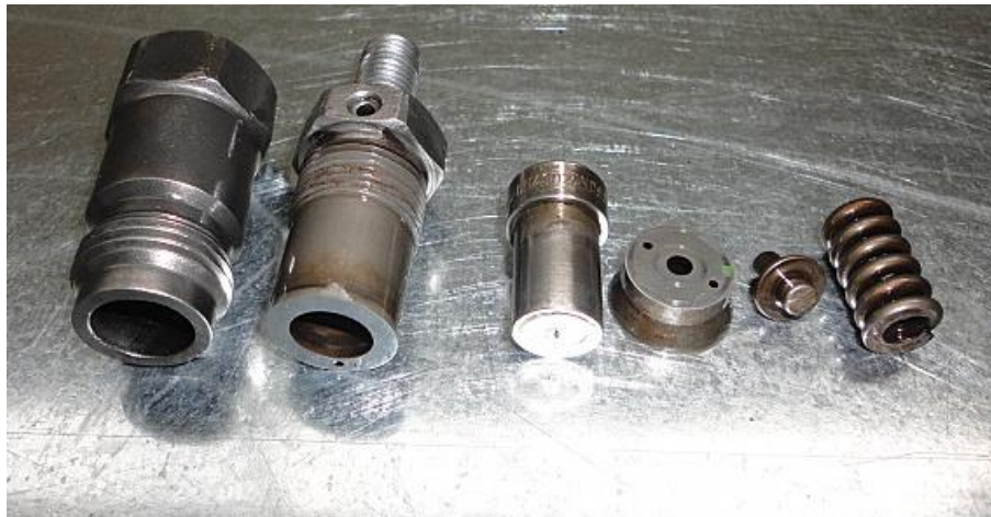
Figura 4.76. Inyector 4 Despiece del inyector
