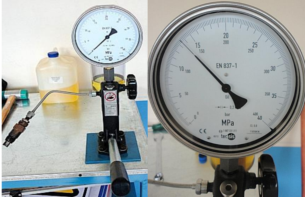
Figura 4.99. Inyector 4 Prueba de presión de apertura
