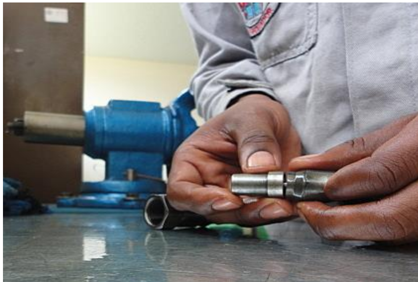
Figura 4.119. Inyector 4 Introduciendo tobera en el cuerpo de inyector
