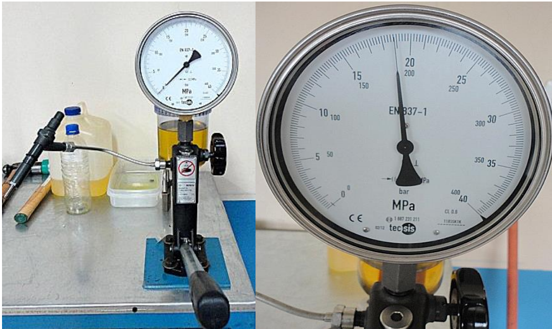
Figura 4.35. Inyector 3 Prueba de presión de apertura
