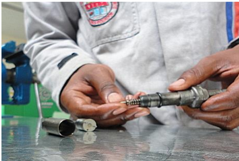
Figura 4.37. Inyector 3 Introduciendo segundo resorte de compresión
