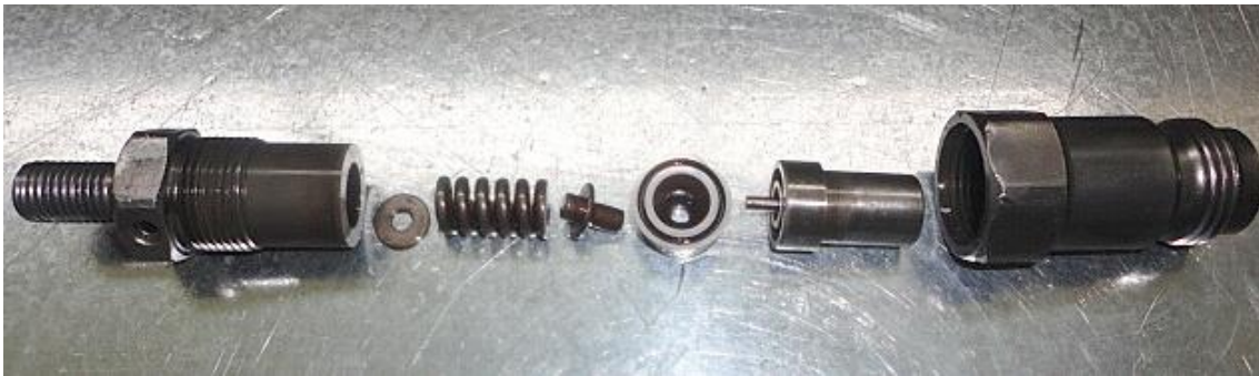
Figura 4.60. Inyector 2 Despiece del inyector
