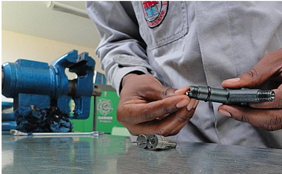
Figura 4.25. Inyector 4 Introduciendo varilla de empuje
