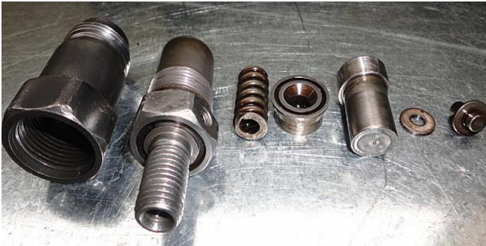
Figura 4.80. Inyector 1 Despiece del inyector
