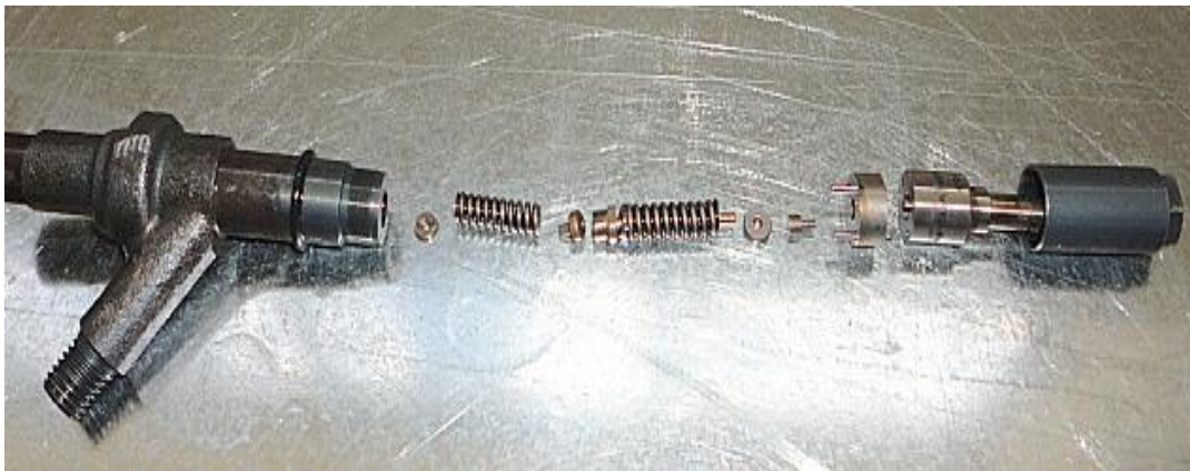
Figura 4.24. Inyector 4 Despiece del inyector
