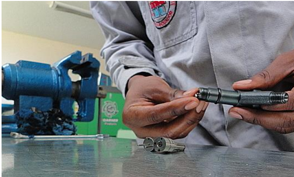
Figura 4.41. Inyector 4 Introduciendo asiento de muelle
