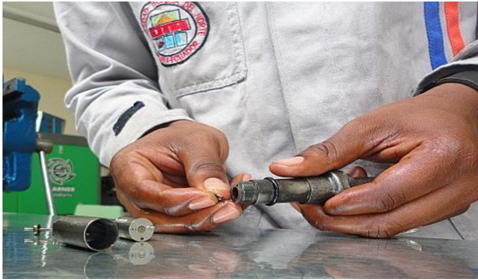
Figura 4.29. Inyector 1 Introduciendo rodela para la primera presión de apertura
