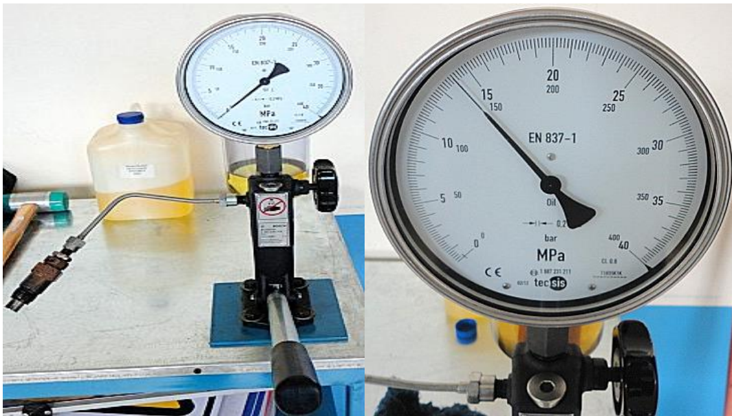
Figura 4.55. Inyector 3 Prueba de presión de apertura
