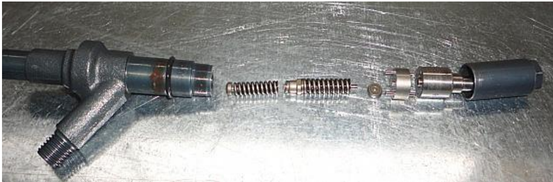
Figura 4.16. Inyector 2 Despiece de inyector
