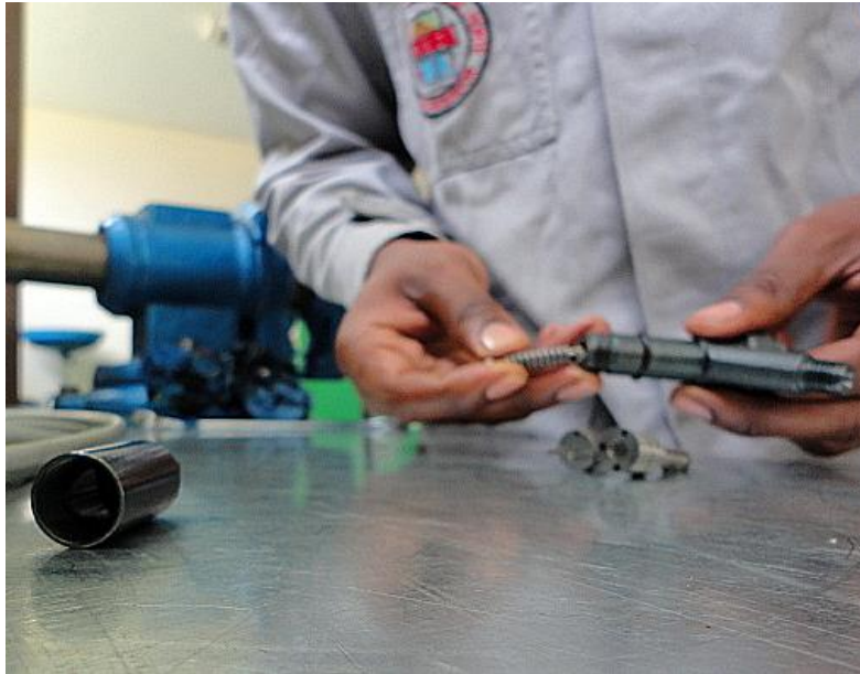
Figura 4.17. Inyector 2 Introduciendo resorte de compresión
