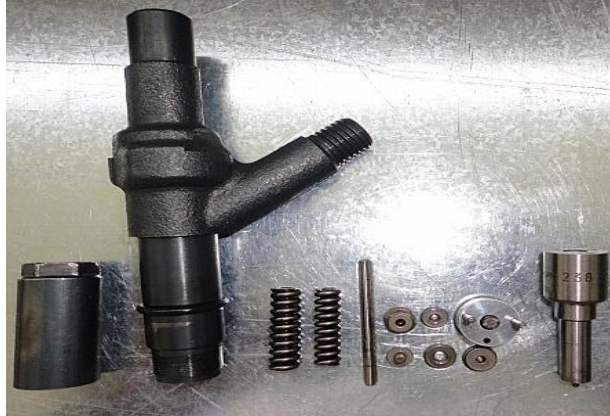
Figura 4.4. Despiece del inyector
