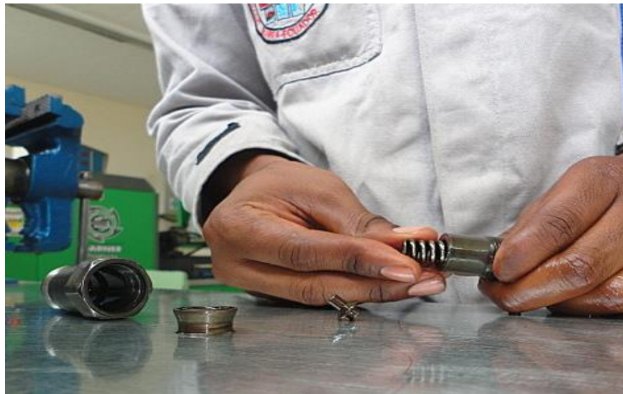
Figura 4.90. Inyector 2 Introduciendo resorte de compresión
