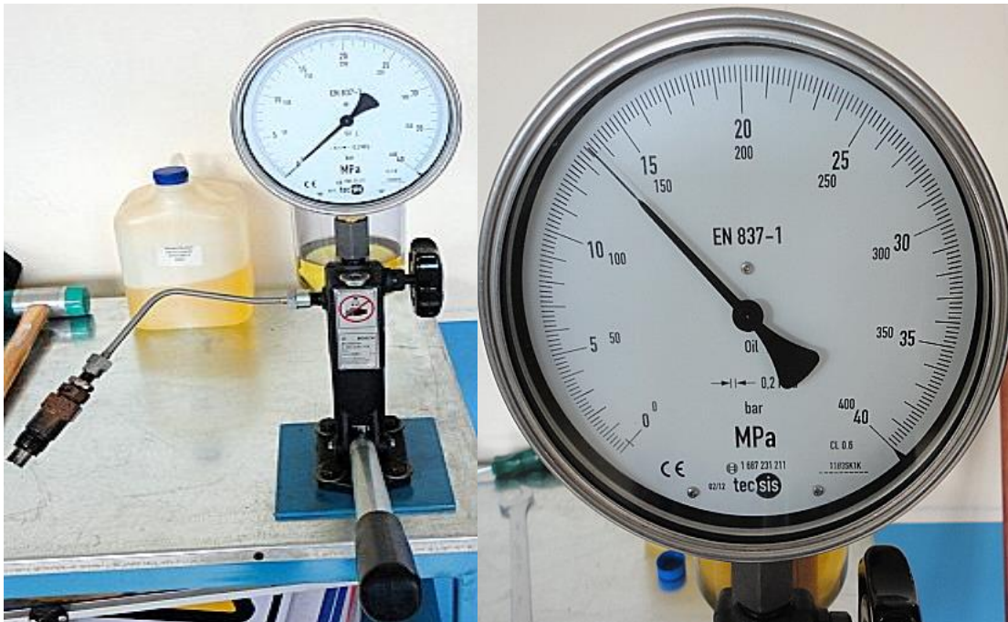
Figura 4.95. Inyector 3 Prueba de presión de apertura
