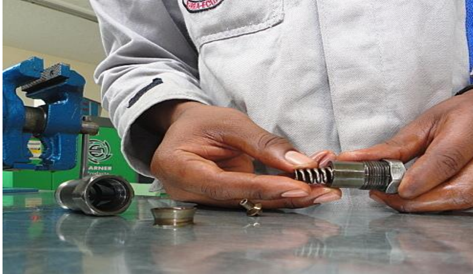
Figura 4.94. Inyector 3 Introduciendo resorte de compresión
