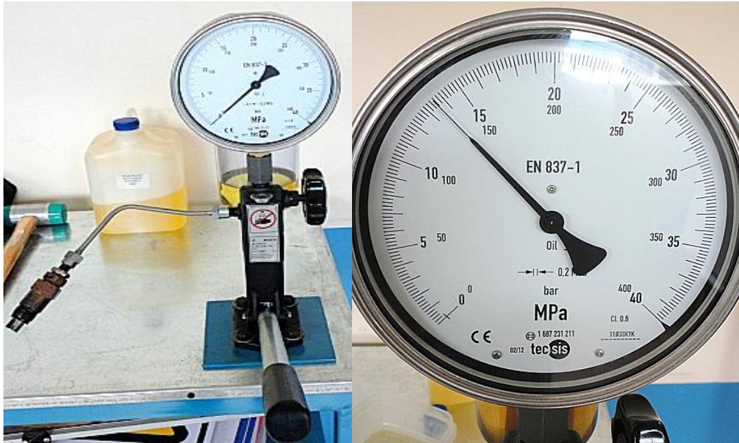
Figura 4.120. Inyector 2 Prueba de presión de apertura
