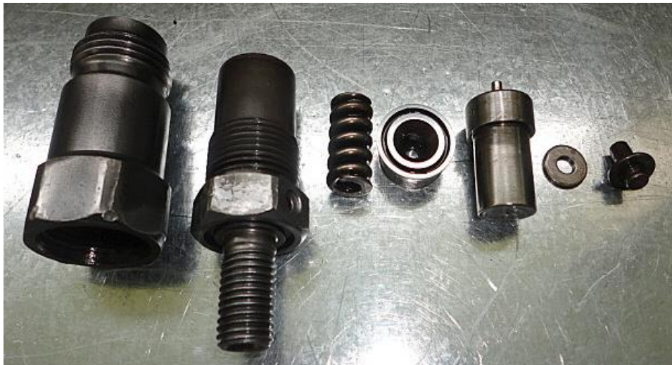
Figura 4.118. Inyector 4 Despiece del inyector
