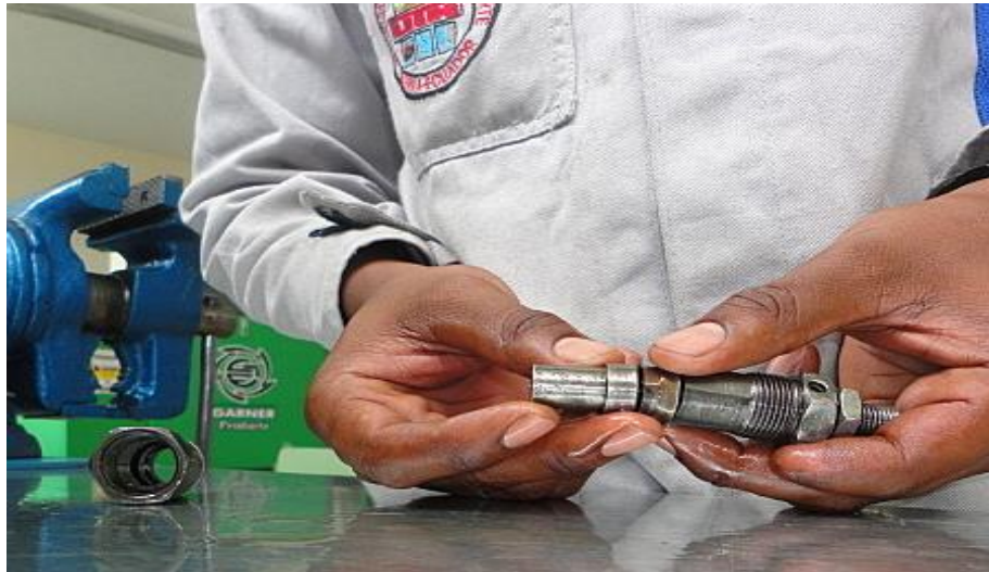
Figura 4.98. Inyector 4 Introduciendo tobera
