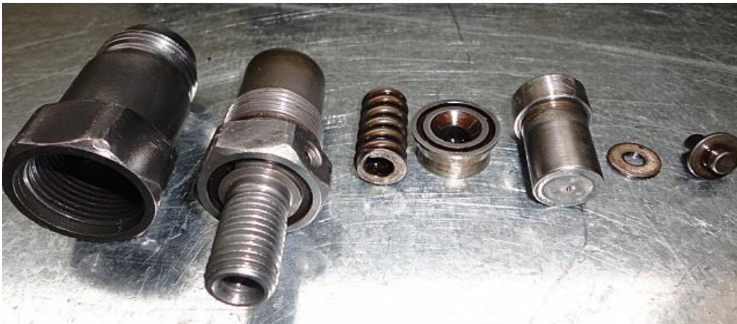
Figura 4.97. Inyector 4 Despiece del inyector
