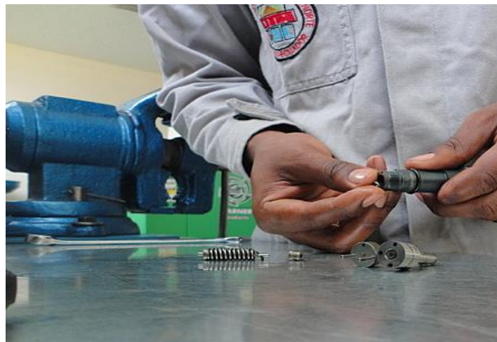
Figura 4.13. Inyector 1 Introduciendo primera rodela de presión
