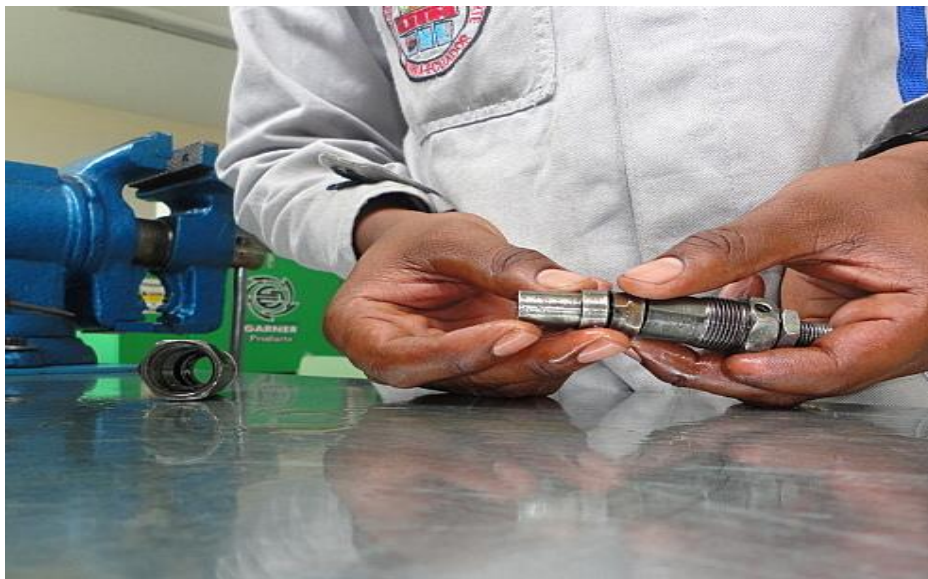
Figura 4.77. Inyector 4 Introduciendo tobera
