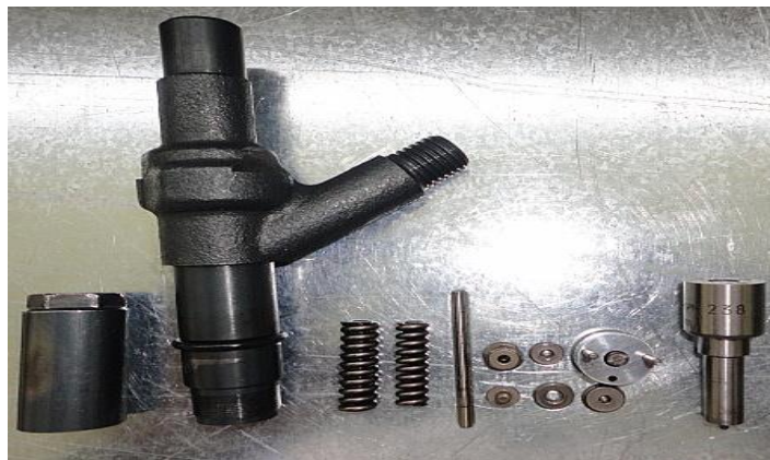
Figura 4.36. Inyector 3 Despiece del inyector
