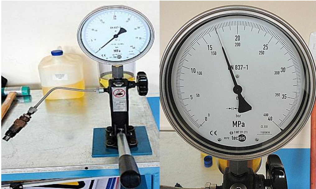
Figura 4.62. Inyector 2 Prueba de presión de apertura
