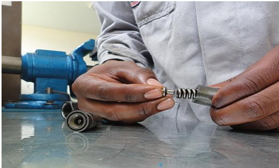
Figura 4.115. Inyector 3 Introduciendo resorte de compresión y varilla de empuje
