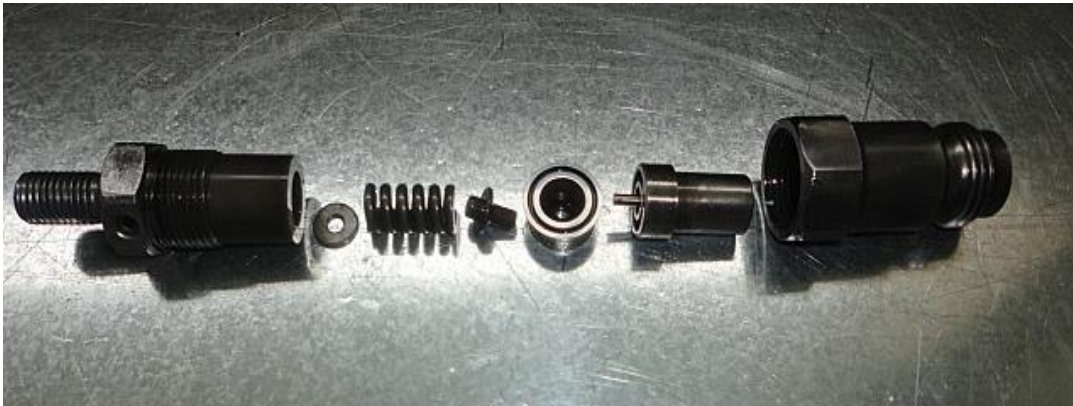
Figura 4.68. Inyector 2 Despiece del inyector
