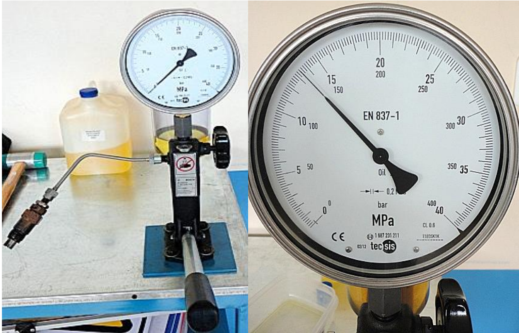
Figura 4.112. Inyector 2 Prueba de presión de apertura
