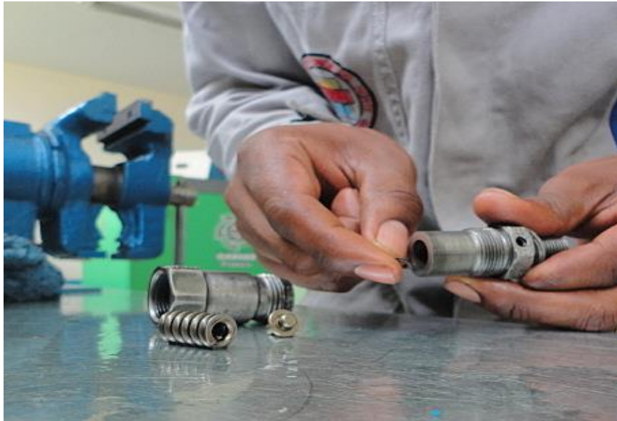
Figura 4.111. Inyector 2 Introduciendo rodela de presión
