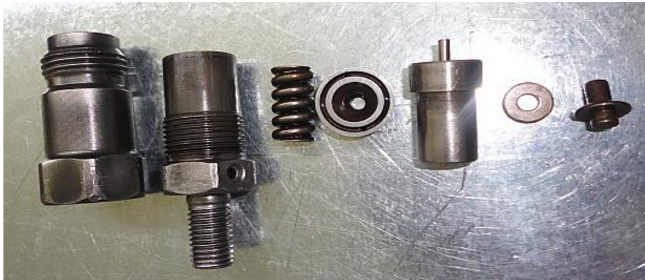
Figura 4.101. Inyector 1 Despiece del inyector
