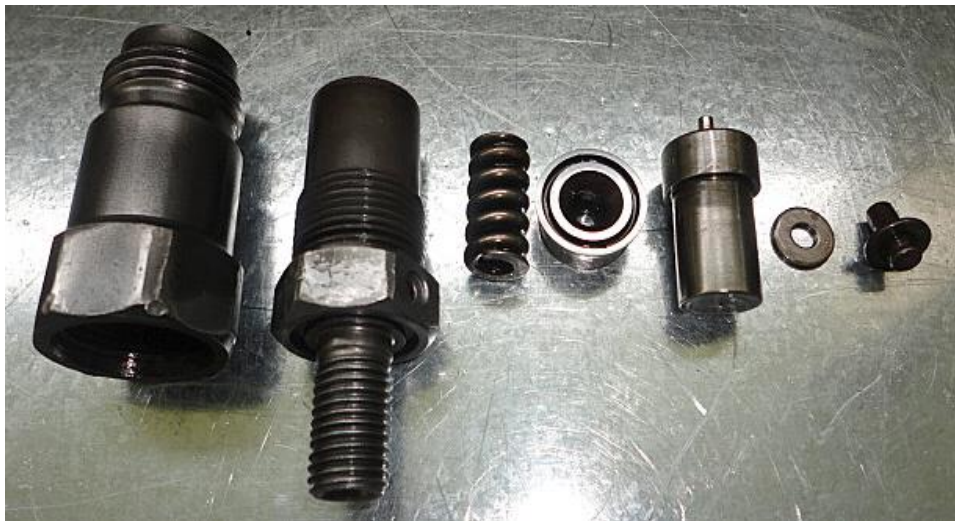
Figura 4.114. Inyector 3 Despiece del inyector
