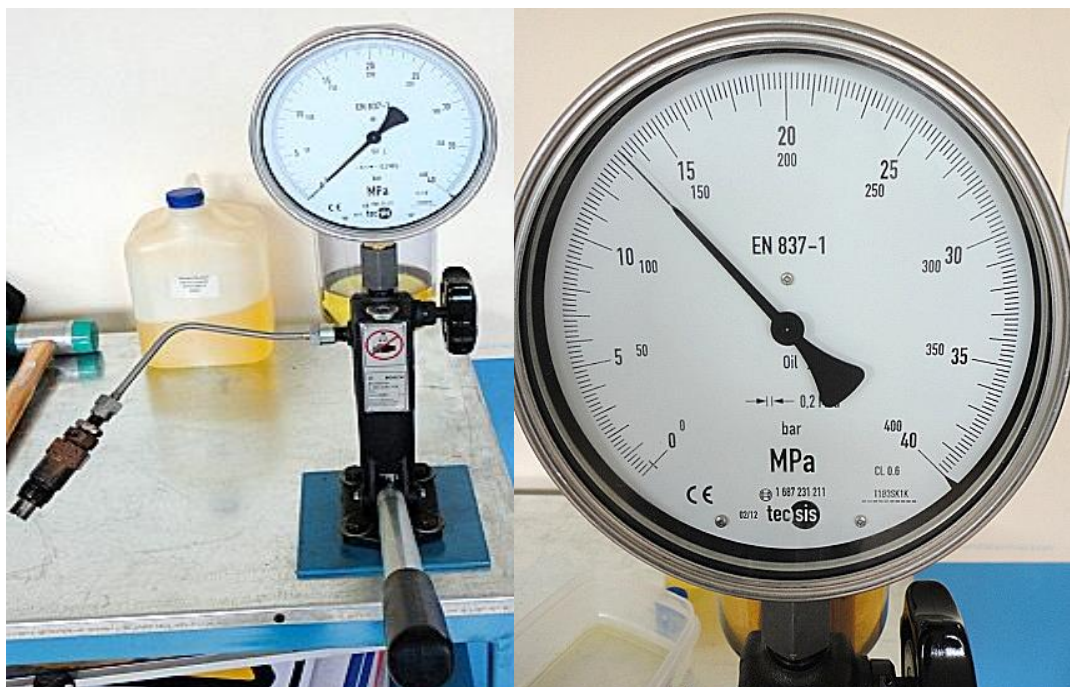
Figura 4.116. Inyector 3 Prueba de presión de apertura
