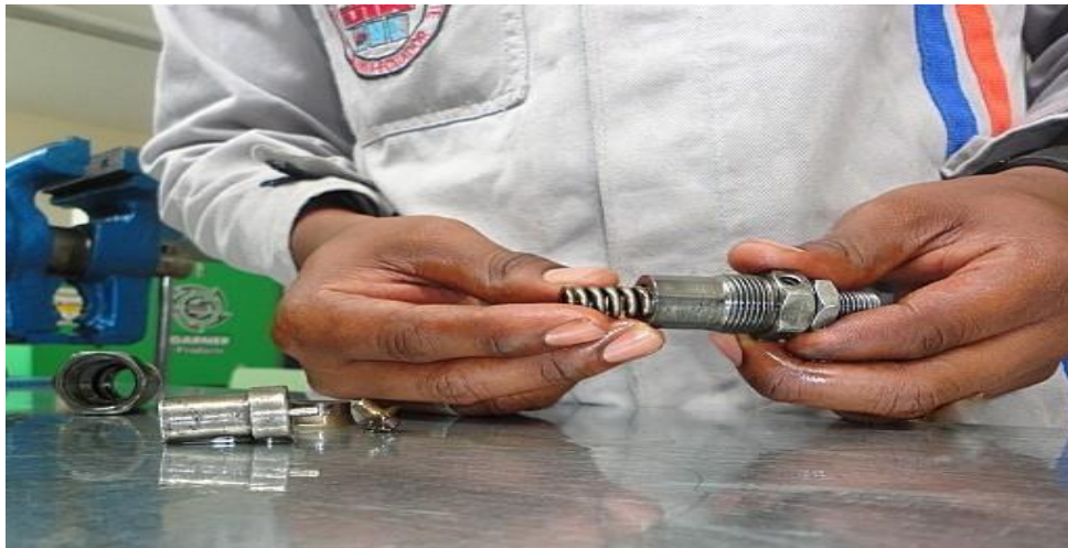
Figura 4.69. Inyector 2 Introduciendo resorte de compresión
