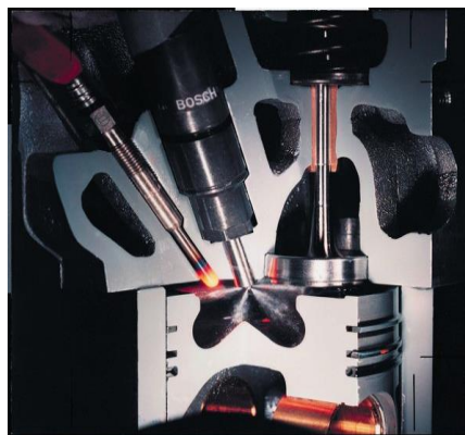
Figura 2.2. Cámara de combustión.
