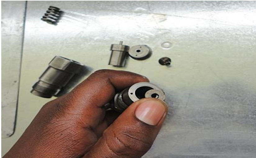
Figura 4.53. Inyector 2 Introduciendo rodela de presión
