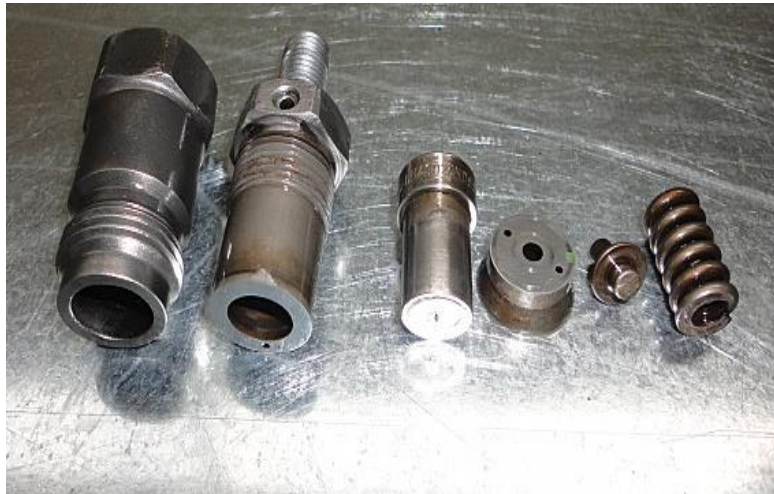
Figura 4.52. Inyector 2 Despiece del inyector
