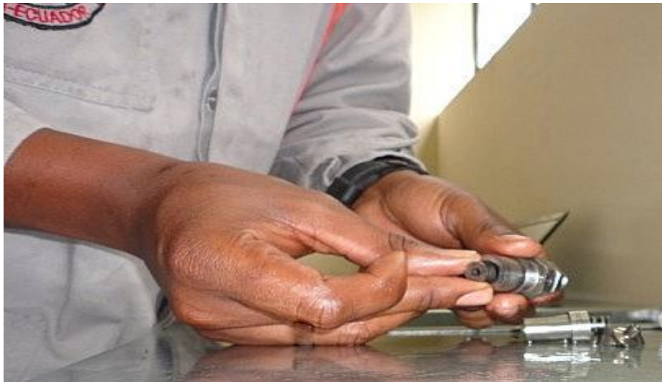
Figura 4.49. Inyector 1 Introduciendo rodela de presión
