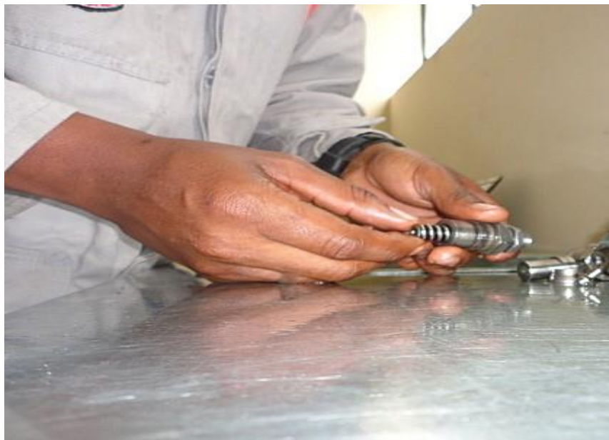
Figura 4.57. Inyector 3 Introduciendo resorte de compresión
