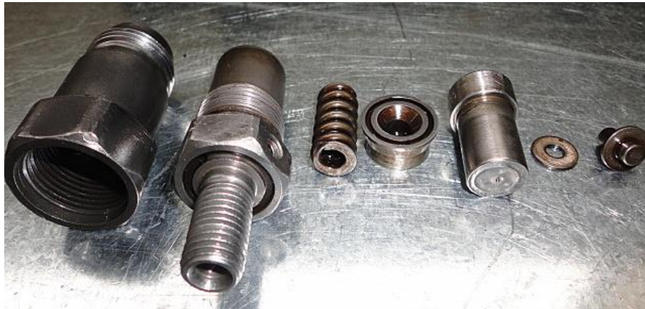
Figura 4.56. Inyector 3 Despiece del inyector
