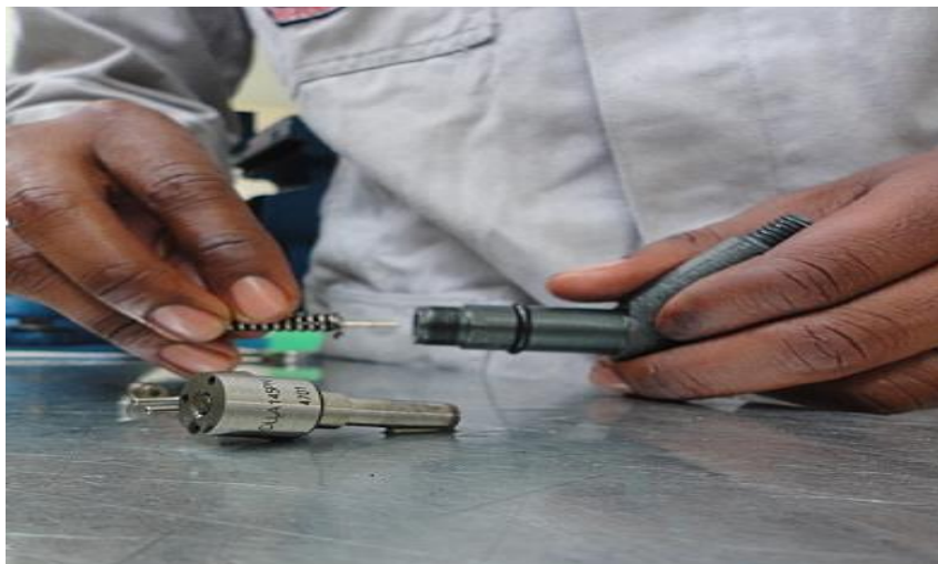
Figura 4.21. Inyector 3 Introduciendo segundo resorte de compresión
