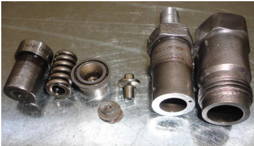
Figura 4.89. Inyector 2 Despiece del inyector
