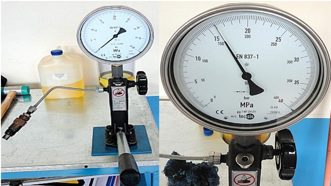
Figura 4.51. Inyector 2 Prueba de presión de apertura
