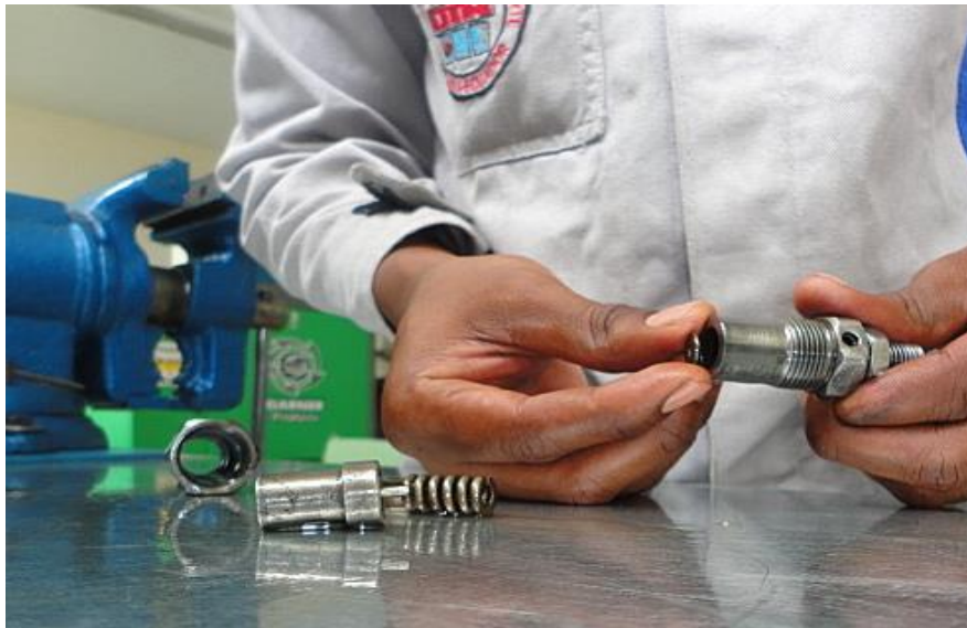
Figura 4.65. Inyector 1 Introduciendo rodelas de presión
