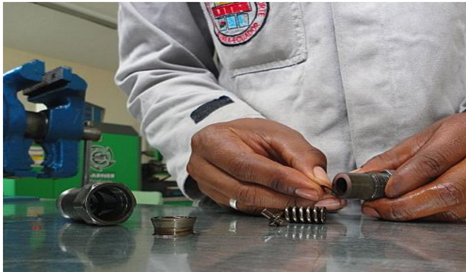
Figura 4.86. Inyector 1 Introduciendo rodelas de presión
