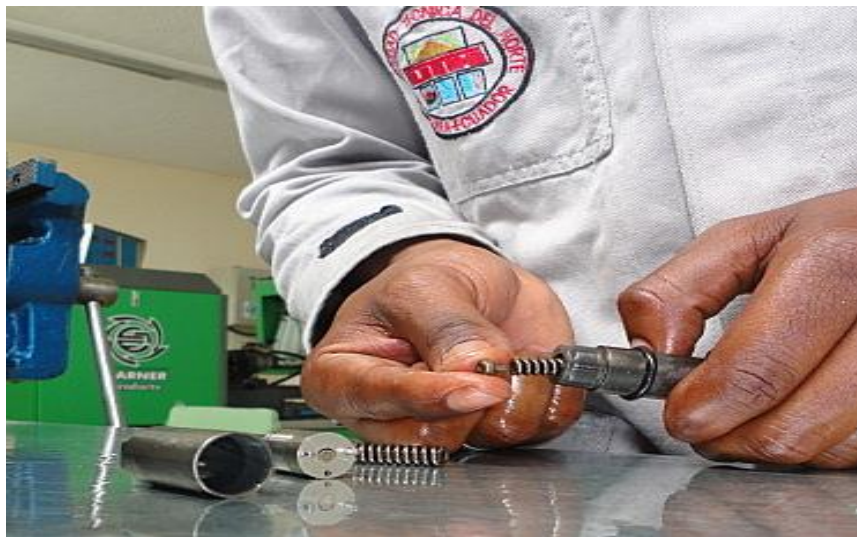
Figura 4.33. Inyector 2 Introduciendo primer resorte de compresión
