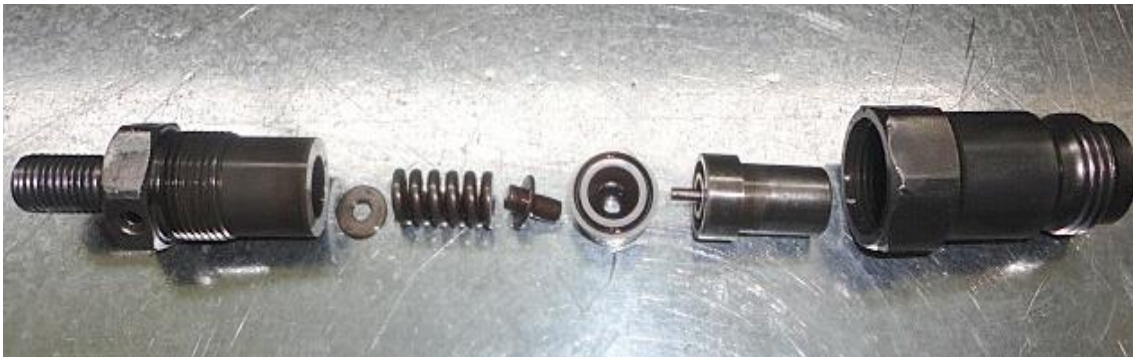
Figura 4.64. Inyector 1 Despiece del inyector
