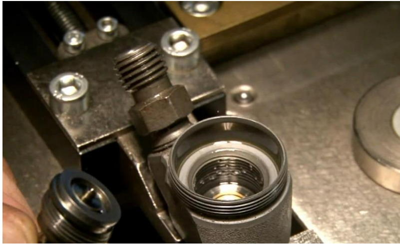
Figura 58. Desmontaje de la varilla de presión.
