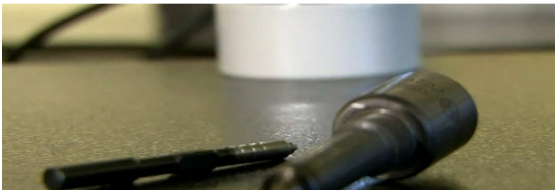
Figura 39. Tobera y aguja del inyector.
