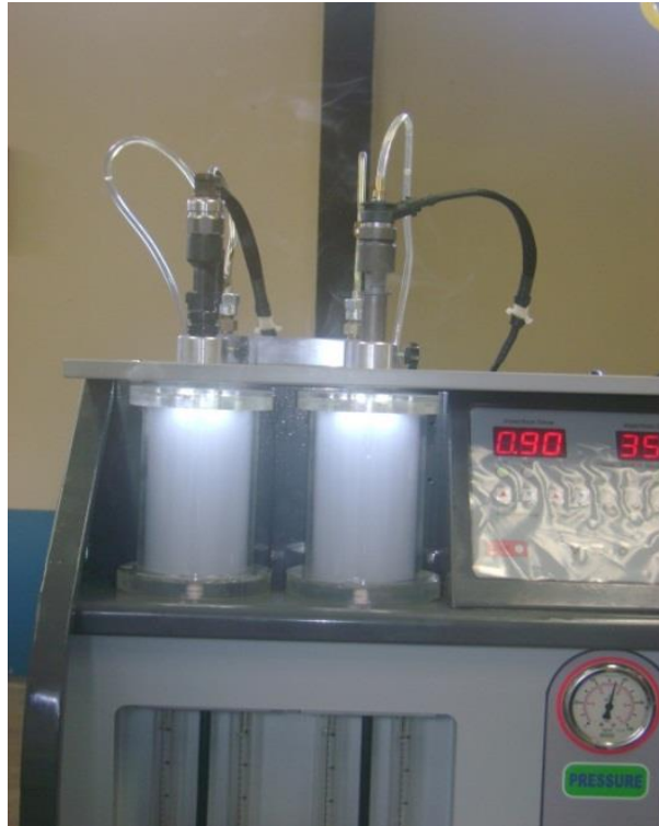
Figura 68. Montaje del inyector CRDi al banco de pruebas UTN.
