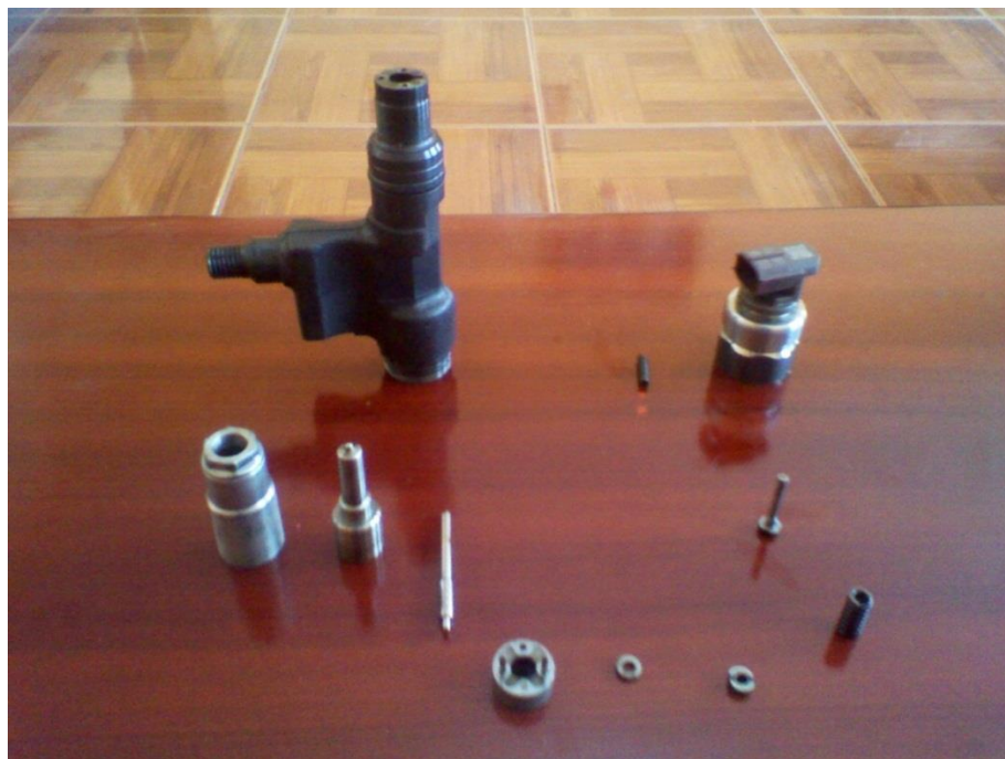
Figura 35. Inyector denso CRDi.
