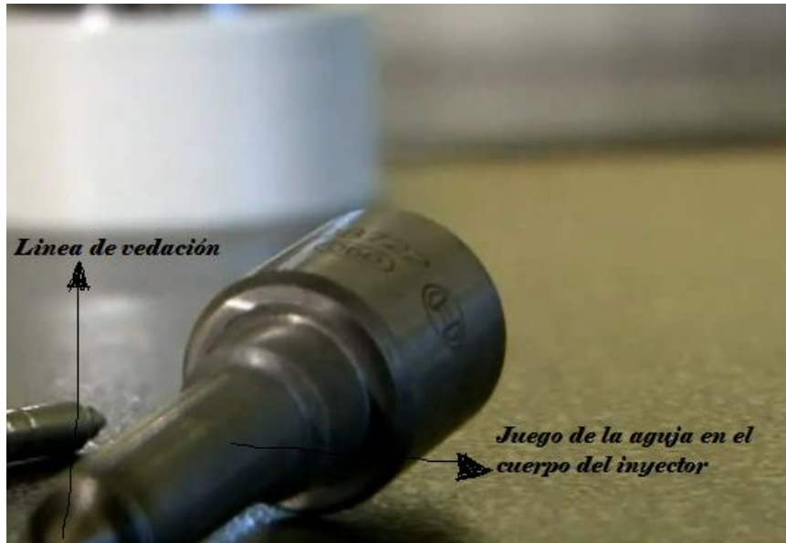
Figura 48. Juego de la aguja en el cuerpo del inyector.
