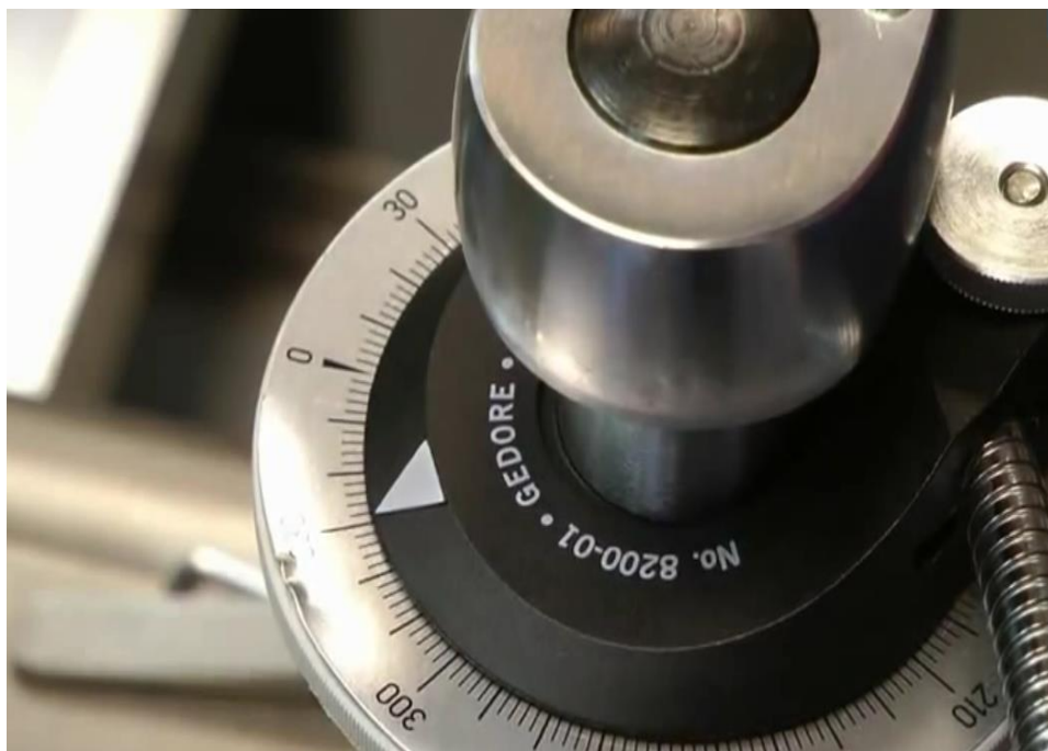
Figura 65. Torquimetro aplicando 15 a 20 libras.
