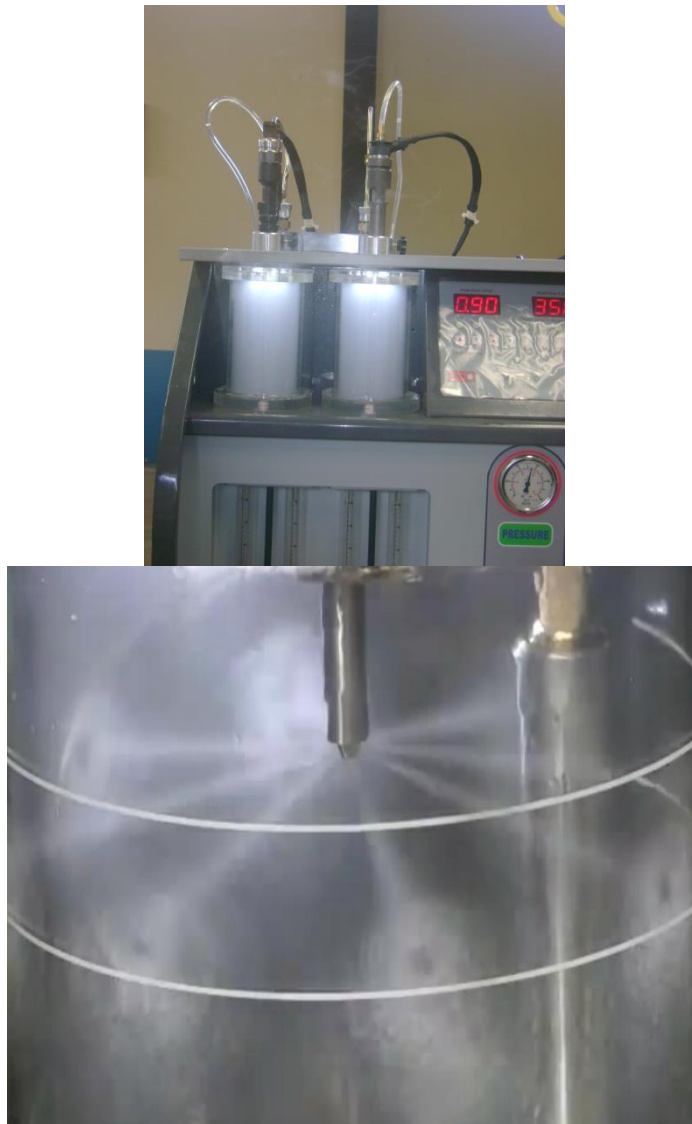
Figura 49. Inyector Bosch de 8 orificios.
