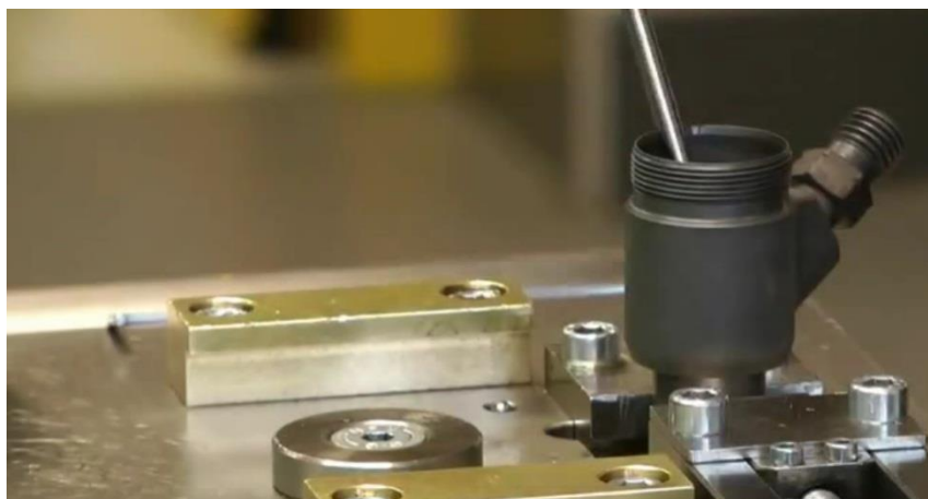
Figura 61. Montaje de la varilla de presión.
