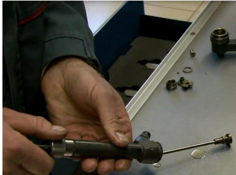
Figura 59. Desmontaje del estrangulador y la varilla de presión.
