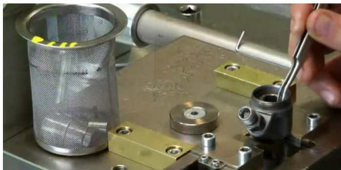
Figura 54. Desmontaje de los elementos internos del inyector.
