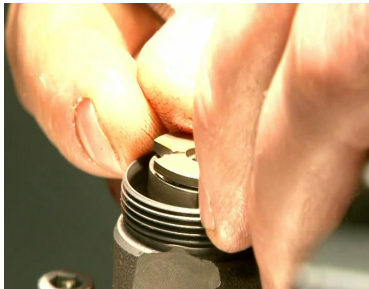
Figura 57. Desmontaje de la electroválvula.
