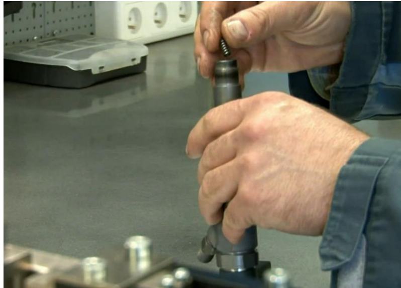
Figura 66. Montaje del muelle de presión.
