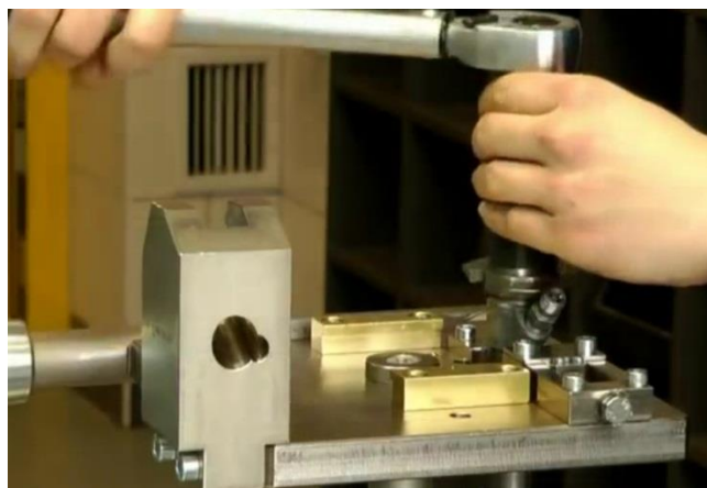
Figura 53. Desmontaje del solenoide.
