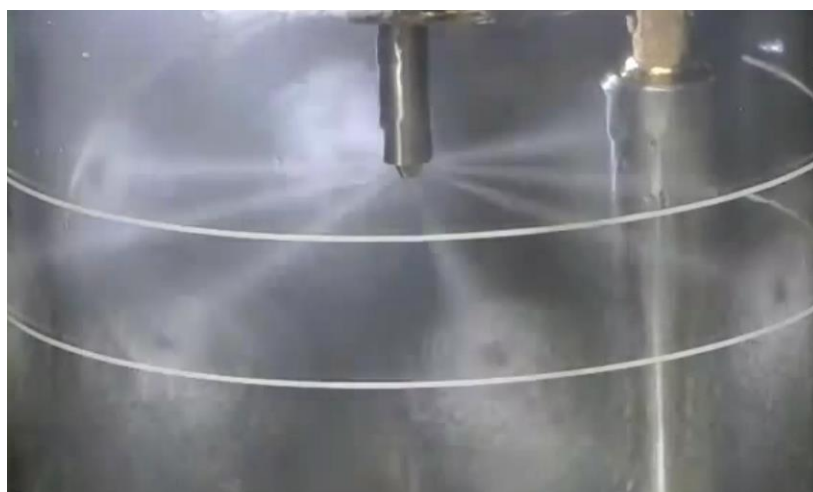
Figura 45. Verificación de la pulverización.
