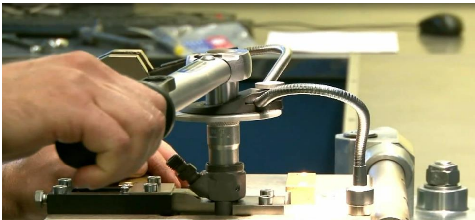
Figura 41. Torquimetro para inyectores CRDi.
