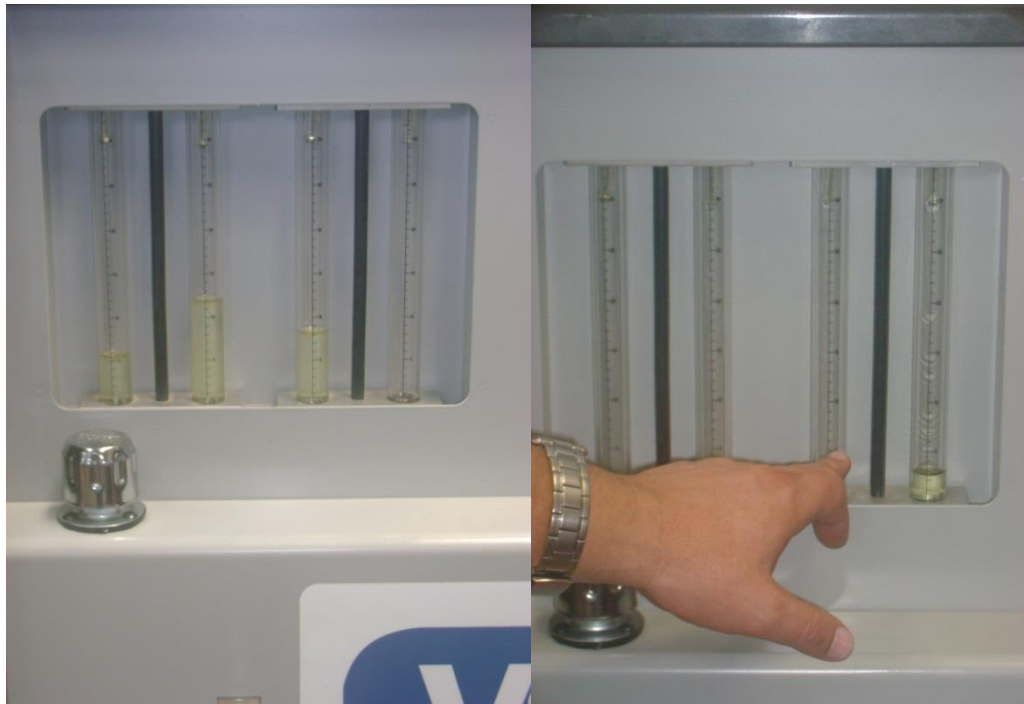
Figura 70. Verificación de entrega y retorno de combustible.
