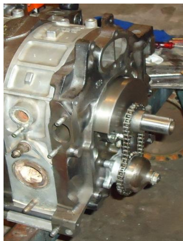
Figura 4.47. Instalación de bomba de aceite Fuente. Autores, 2014
