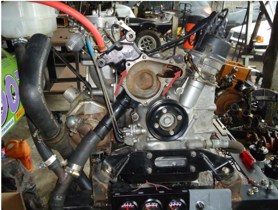
Figura 4.52. Montaje de bomba de agua
