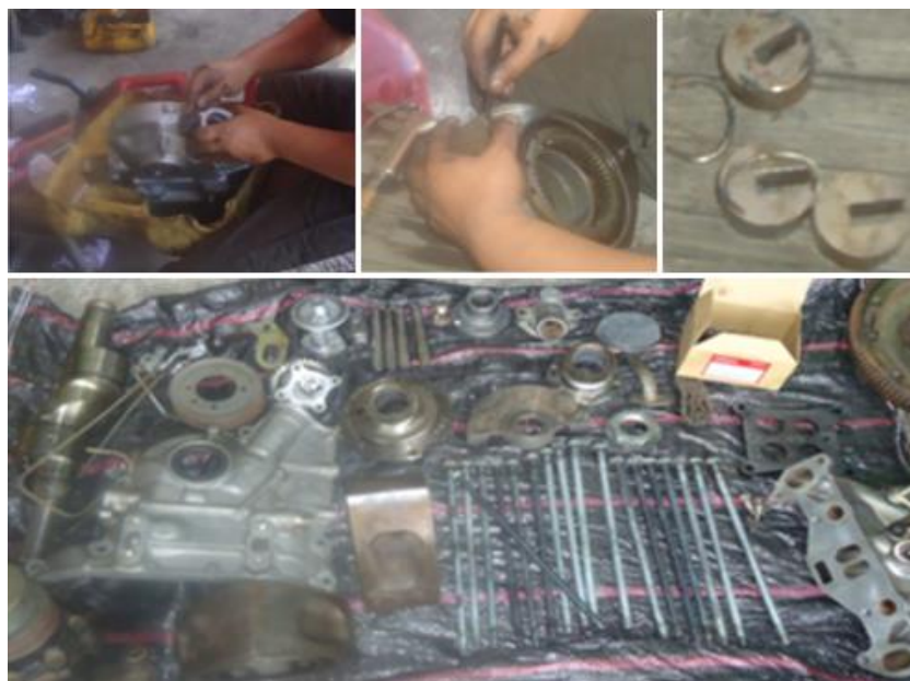
Figura 4.31. Limpieza de elementos del motor Fuente. Autores, 2014
