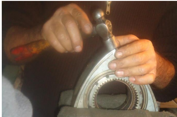
Figura 4.34. Readecuación de rotores
