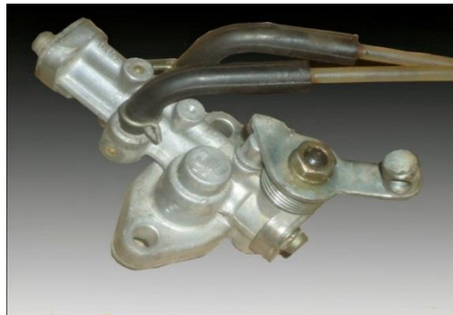
Figura 2.26. Bomba dosificadora de aceite Fuente. Autores, 2014
