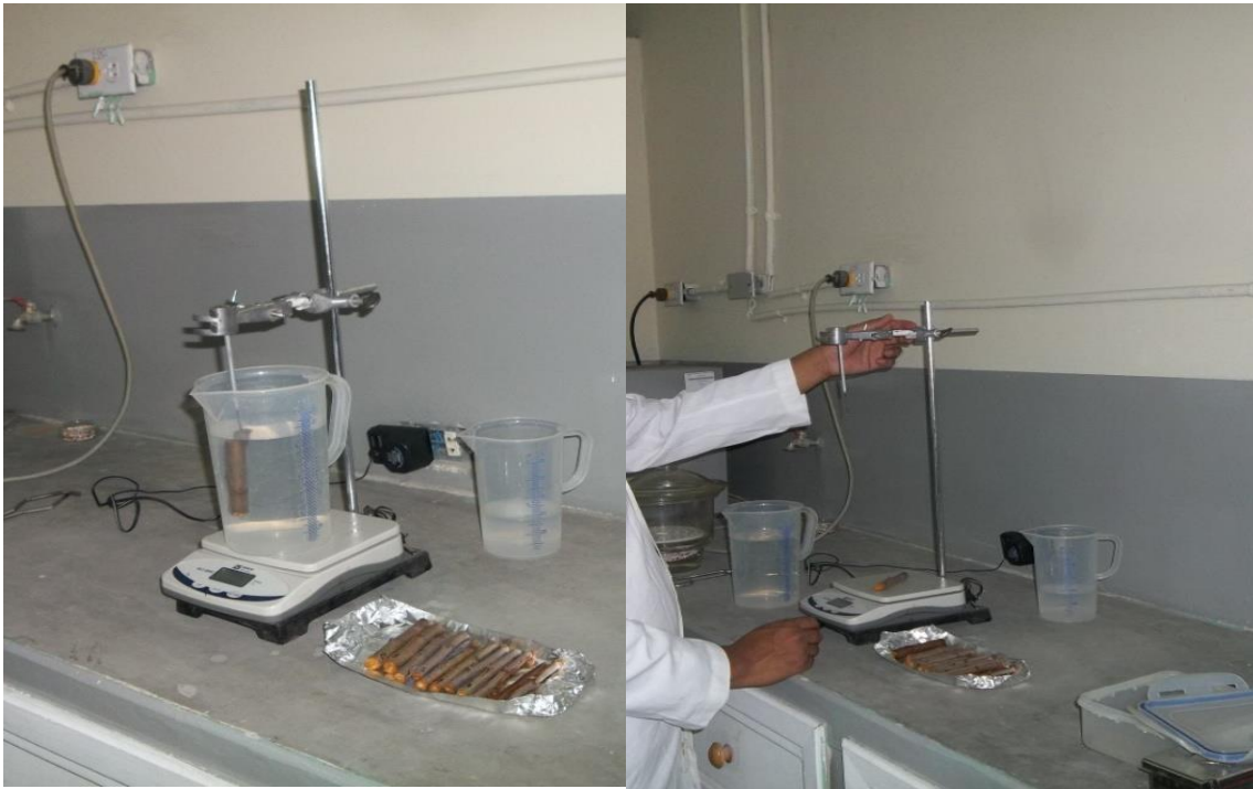
Fotografía N° 10. Determinación de densidad en húmedo.
