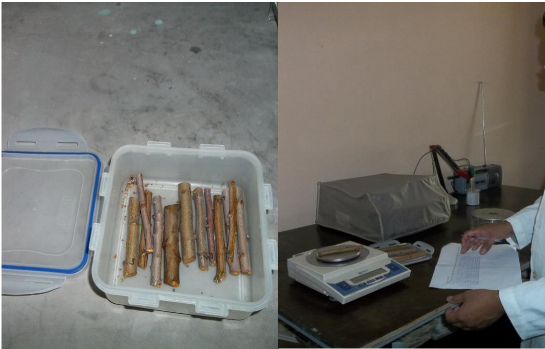
Fotografía N° 12. Medición de curva de desecación
