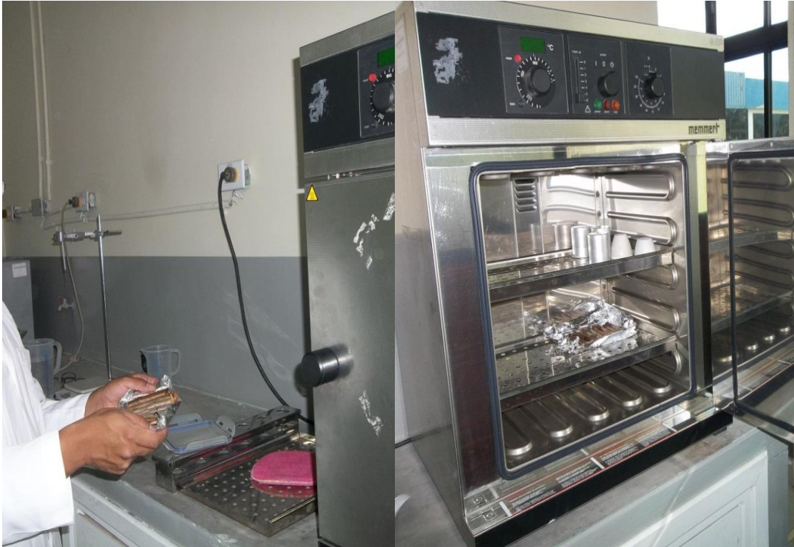
Fotografía N° 11. Determinación de densidad en seco.
