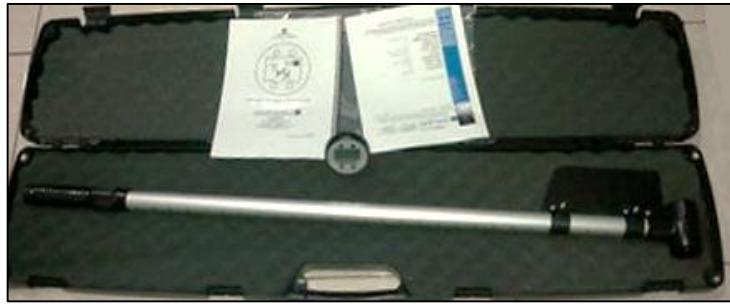
Figura 3.14 Molinete The global water flow probe Elaboración: La autora
