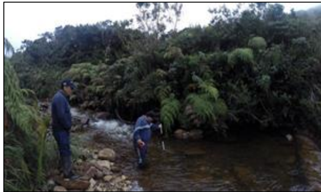
Figura 3.15 Medición de caudal del río Pizán con el método del molinete Elaboración: La autora
