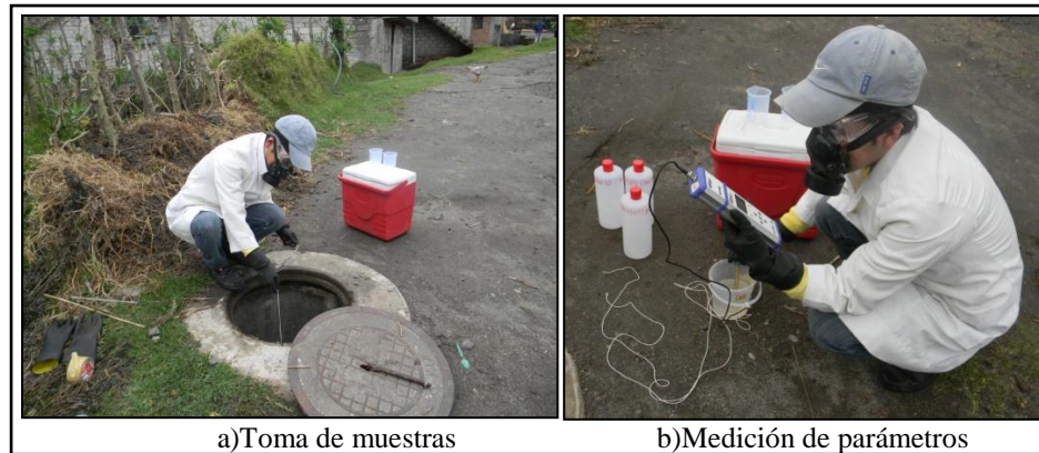
a) Toma de muestras b) Medición de parámetros Figura 3. 5 Muestras – Medición del caudal, pH, Temperatura, Conductibilidad Fuente: Autor
