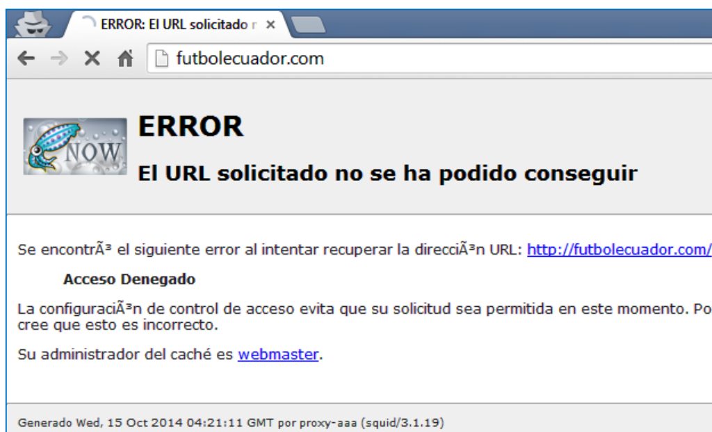
Figura 150. Bloqueo de páginas web mediante proxy transparente.
