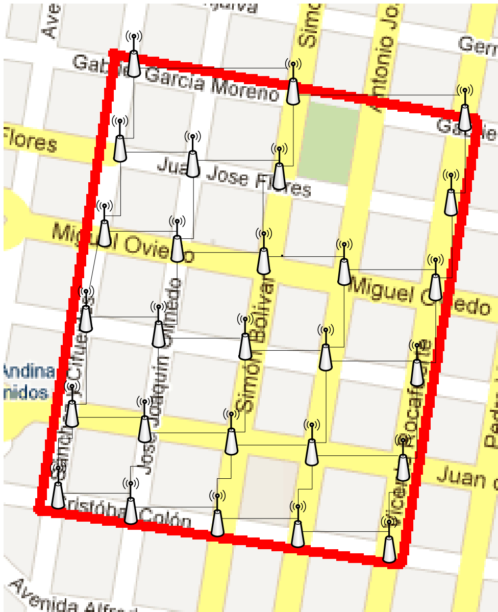
Fig. 4.5.: Conexión tipo malla de los APs
