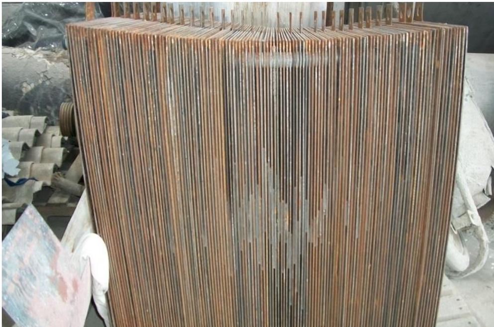
**Placas del sistema de electrocoagulador**
