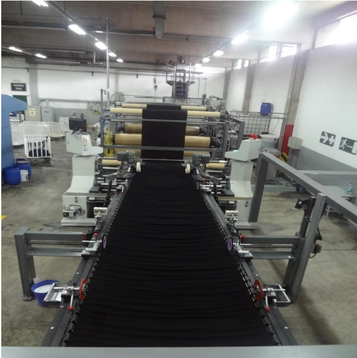
Gráfico N°50 Sobre alimentación de la tela en maquina
