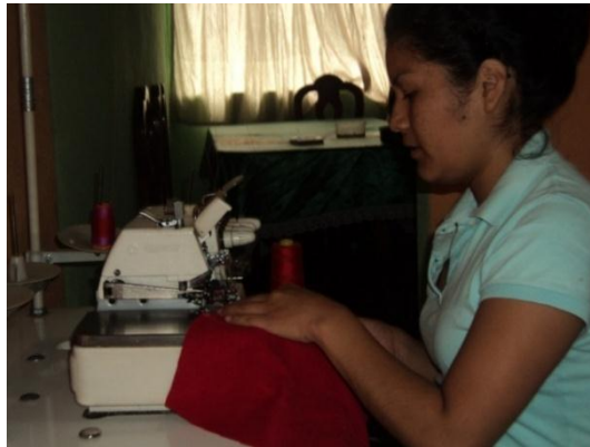
Gráfico N° 103: armar capa en maquina overlock
