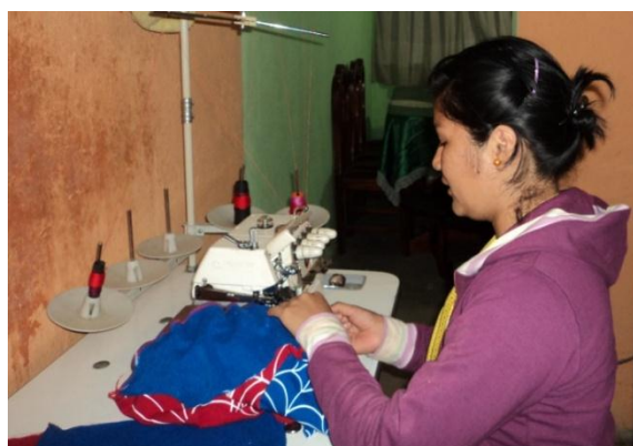
Gráfico N° 105: unión de costuras en máquina overlock disfraz spiderman
