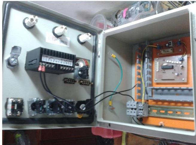
Figura 85. Conexiones del panel de control.
