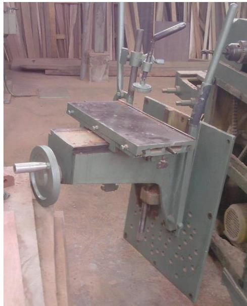
Figura 16. Desmontaje de bancada de la perforadora de madera.
