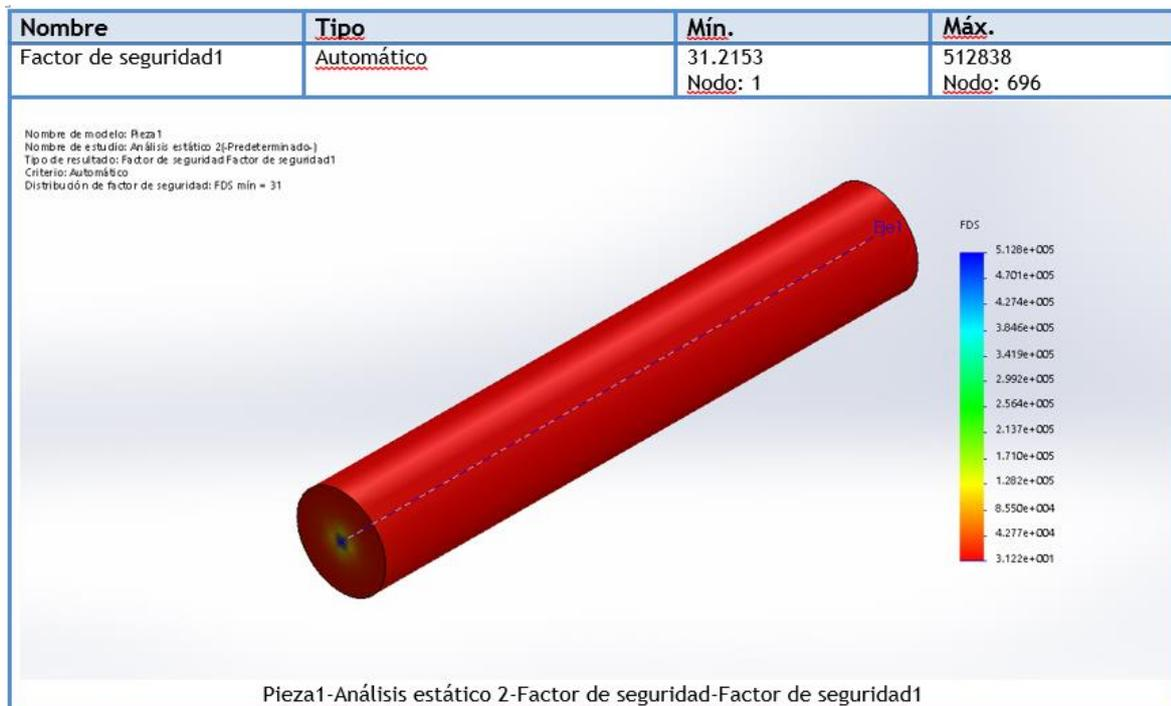
Figura 31. Factor de seguridad, SolidWorks\_Simulation.
