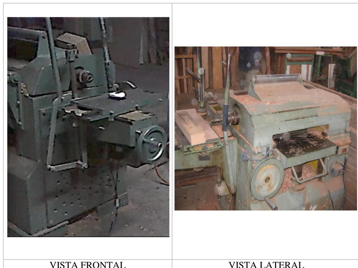
Figura 3. Máquina perforadora lineal de ebanistería
