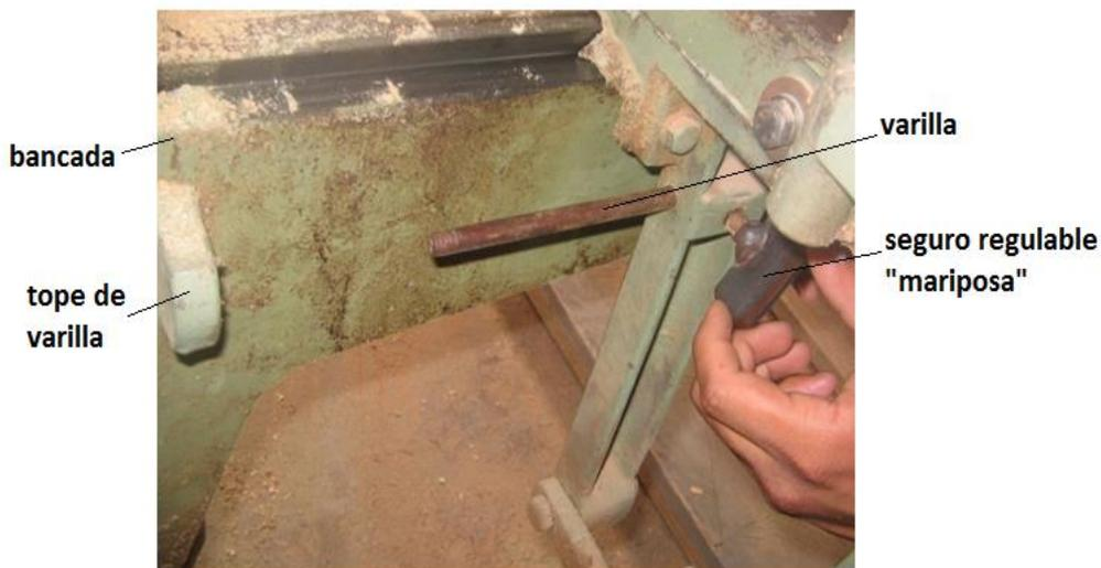
Figura 6. Sistema de topes regulable mediante “mariposa”.
