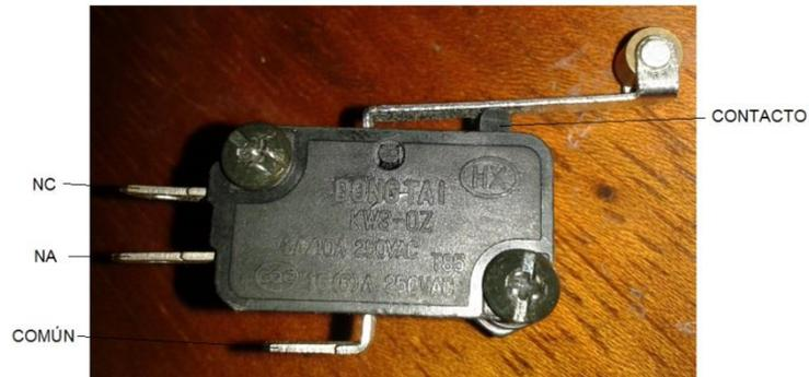
Figura 87. Fin de carrera y sus estados de activación.
