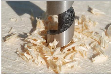
**Figura 1.** Perforación en madera
