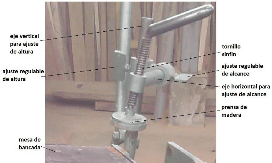
Figura 7. Mecanismo para prensar la madera.
