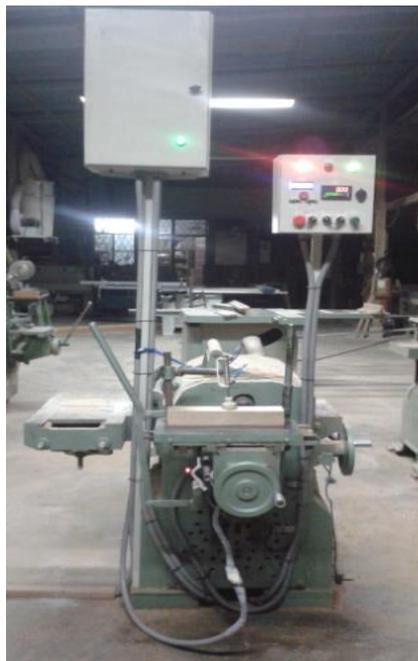
Figura 94. Máquina perforadora lineal de ebanistería modernizada
