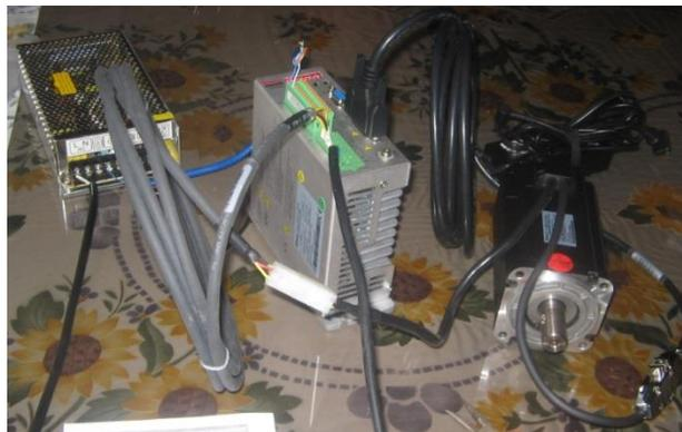
Figura 95. Prueba del servomotor para seleccionar modo de funcionamiento
