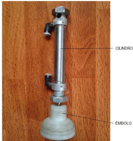
Figura 45. Cilindro de sujeción de madera.
