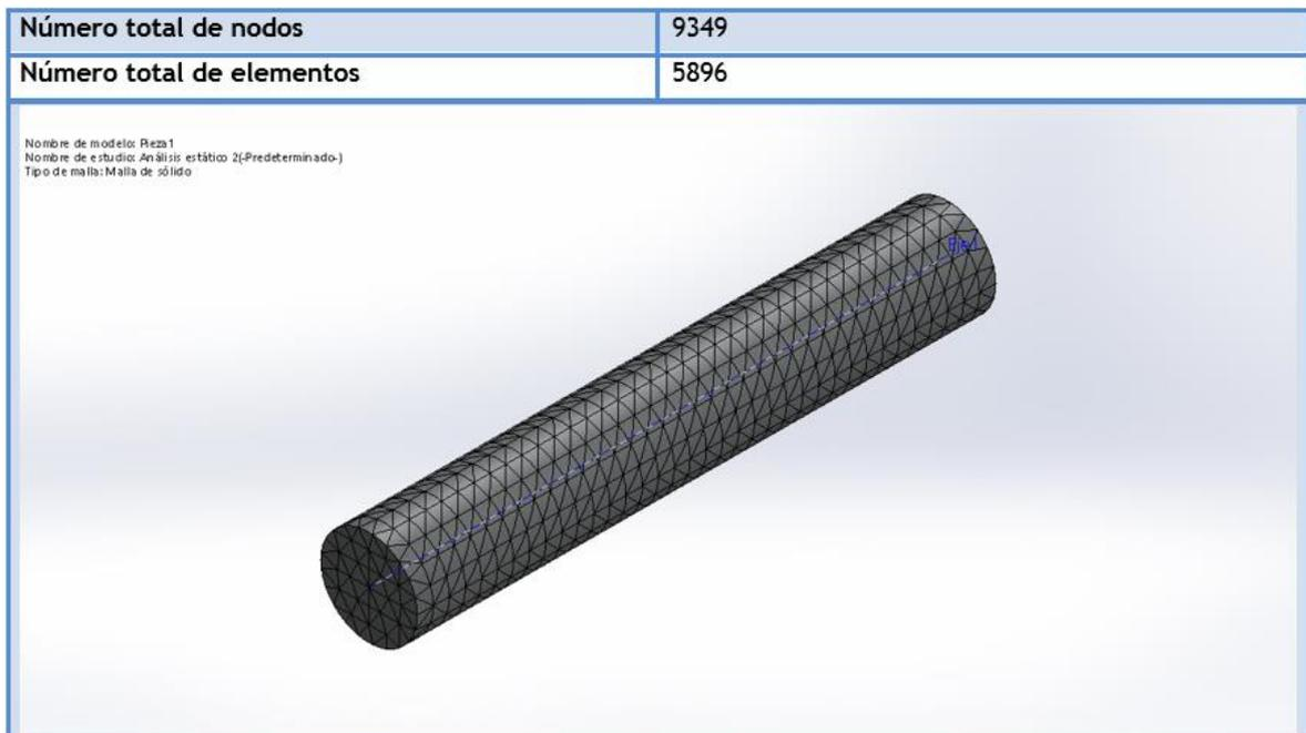
Figura 30. Enmallado del eje, SolidWorks\_Simulation
