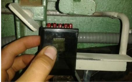
Figura 93. Instalación de LEDs en el mol de 10 pines
