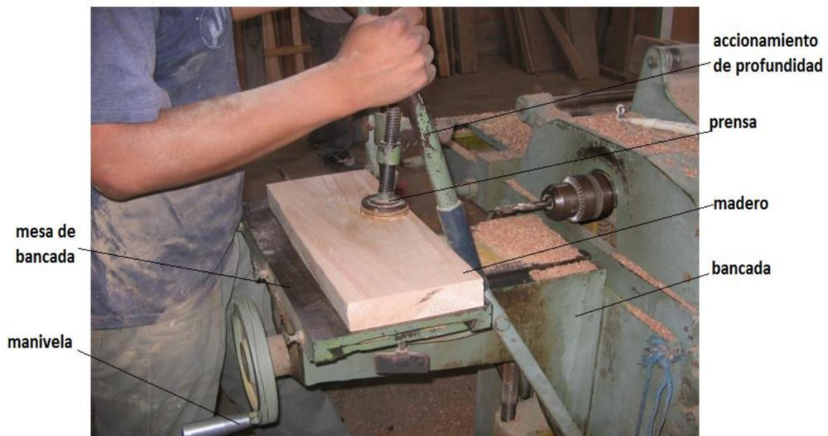
Figura 4. Sistema de perforación antes de la modernización
