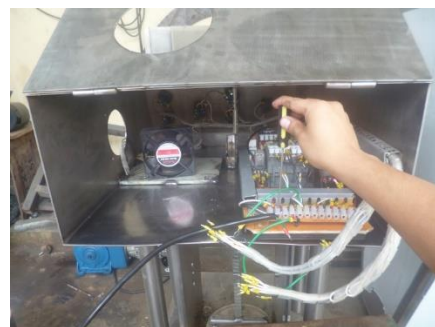
Figura 19 Montaje del tablero de control
