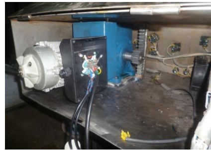
Figura 18 Montaje del motorreductor, piñón y cremallera
