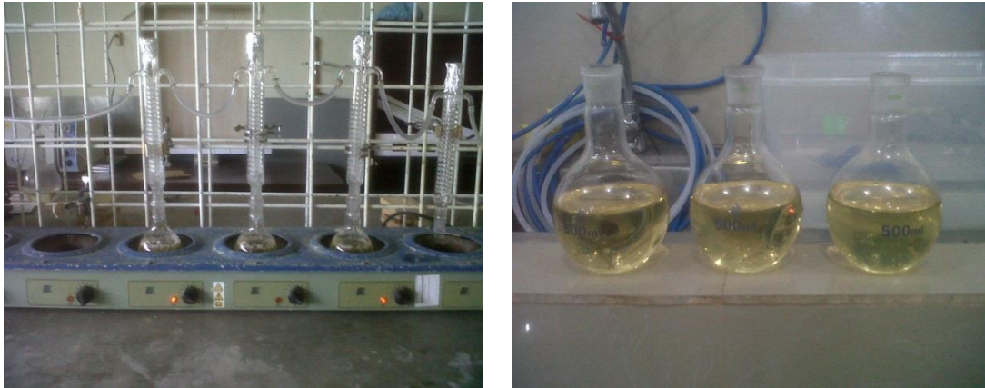
Fotografía 4. Hidrólisis de la sacarosa
