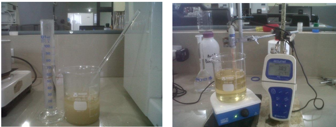
Fotografía 3. Disolución de la sacarosa cristalizada
