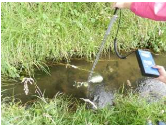
Fotografía 10. Medición de caudal con molinete electrónico.
