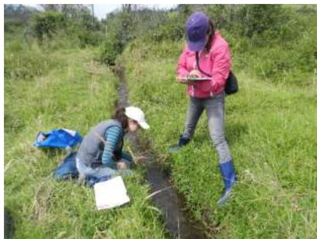
Fotografía 14. Medición de caudales por método de flotador.
