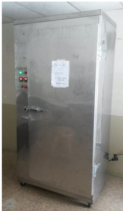
Foto 15: Deshidratador de Bandejas
