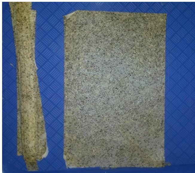
Foto 19: Cortes longitudinales en la lámina
