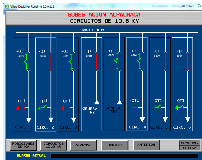
Gráfico N° 43 Diagrama unifilar circuitos de 13,8 kV
