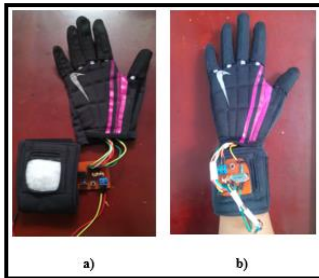
Imagen 81.- a) placa impresa sin broche adhesivo, b) placa impresa con broche adhesivo
