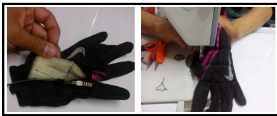
Imagen 66.- Cobertura de una pieza de lycra y esponja para el guante traductor de señas básicas
