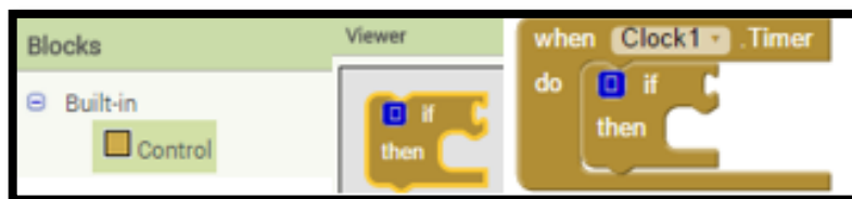
Imagen 130.- Bloque de control de condiciones IF
