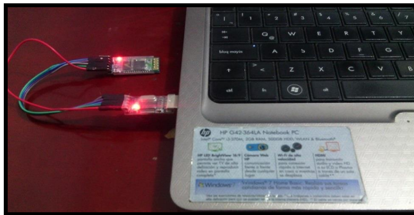
Imagen 89.- Conexión del cable USB-TTL al ordenador
