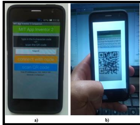
Imagen 117.- a) Opción de ingreso del código de forma manual, b) Opción del Escaneo del código QR
