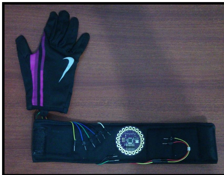
Imagen 82.- Fijación de cables conectores y Arduino Lilypad dentro del broche adhesivo
