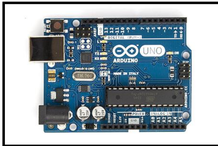
Imagen 22: Identificación de pines de una placa Arduino UNO
