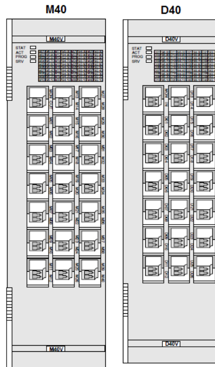
Figura 99. Multiplexor M40 y Demultiplexor D40 de OptiX OSN 8800
