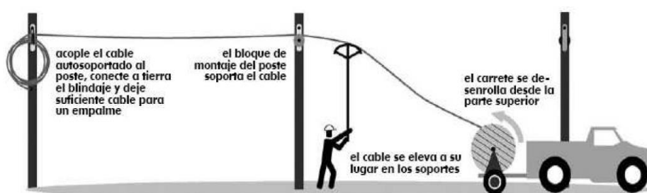
Figura 120. Instalación de fibra óptica por el método de desplazamiento de carrete
