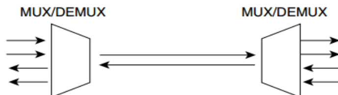
Figura 74. Multiplexación y Demultiplexación en un sistema Bidireccional
