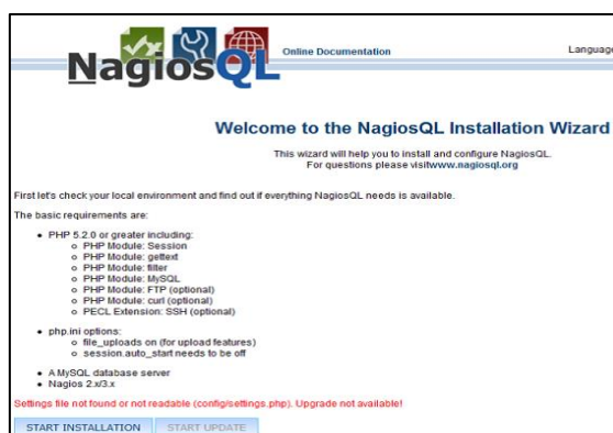
Figura B.1. Requisitos previos para NagiosQL.
