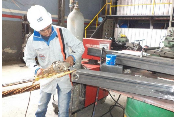
Figura 57. Colocación de bocines y redondeado de los extremos de la pluma.
