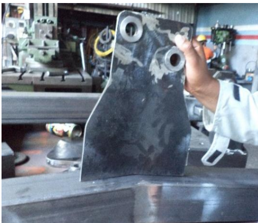
Figura 58. Colocación de soporte para cilindros y refuerzos de la pluma.
