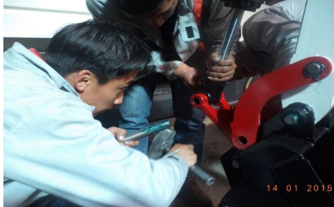
Figura 81. Sujeción del cucharón con los acoples móviles.
