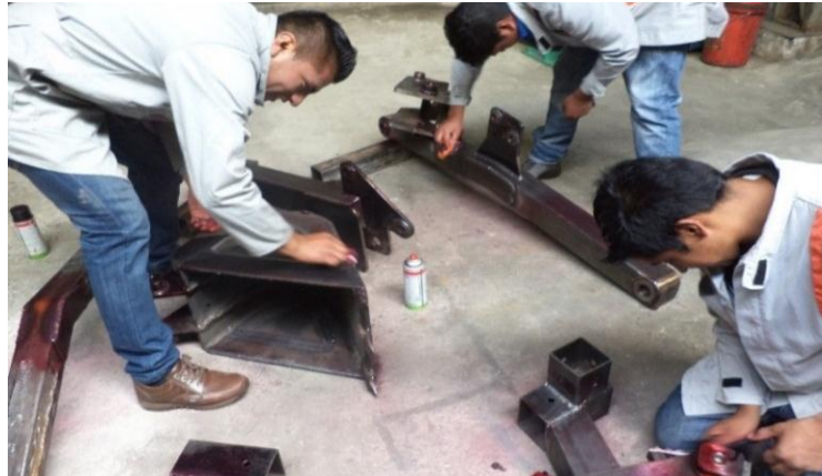
Figura 67. Limpieza de superficie.
