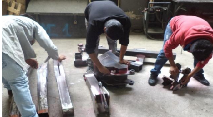
Figura 69. Eliminación del exceso de penetrante.
