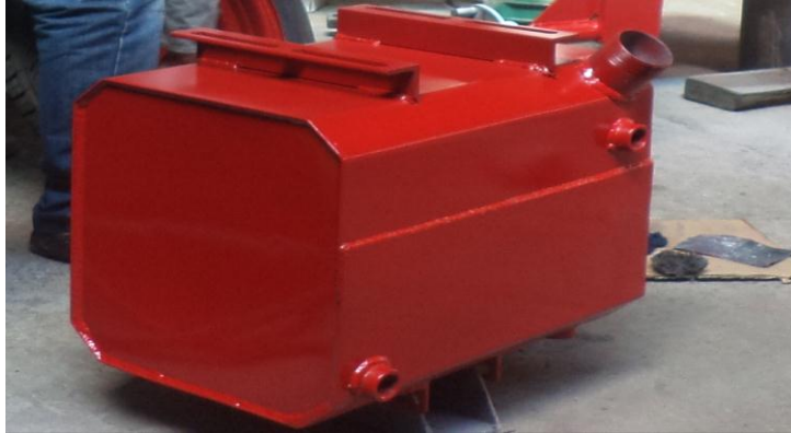
Figura 66. Tanque para aceite hidráulico.
