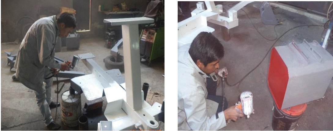
Figura 73. Aplicación de pintura final.
