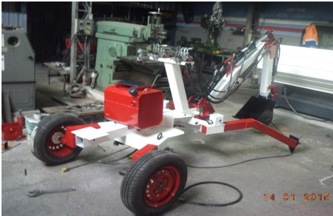
Figura 82. Estructura mecánica de brazo hidráulico ensamblado.
