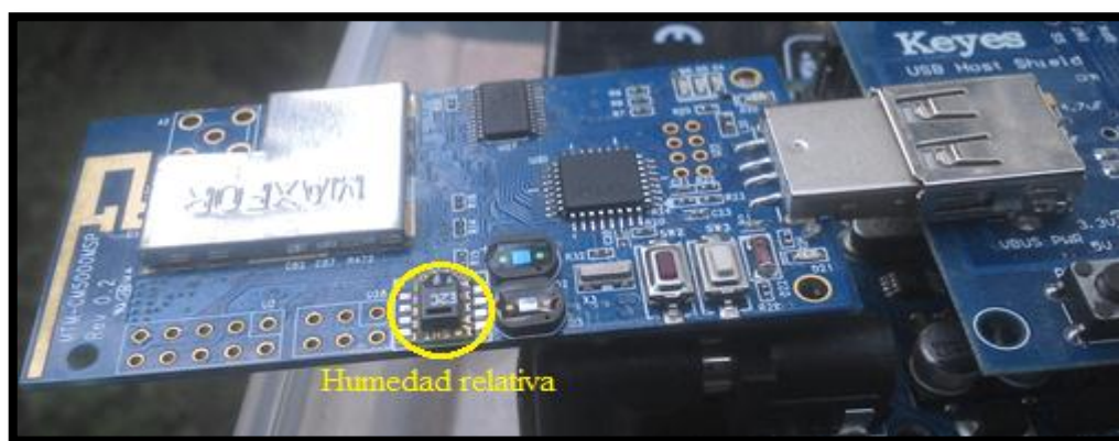
Figura 58. Identificación del sensor de humedad relativa en un nodo sensor instalado.
