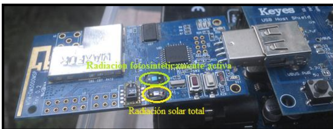
Figura 57. Identificación de los sensores de radiación solar en un nodo sensor instalado.
