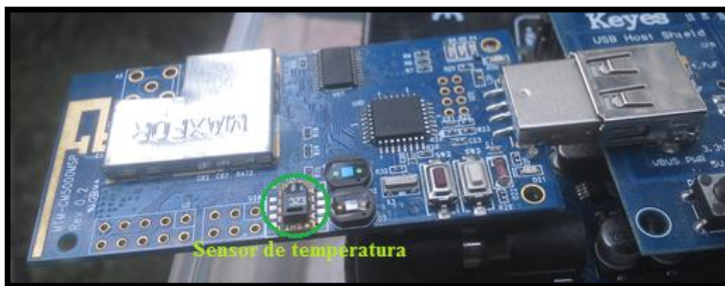
Figura 56. Identificación del sensor de temperatura en un nodo sensor instalado.
