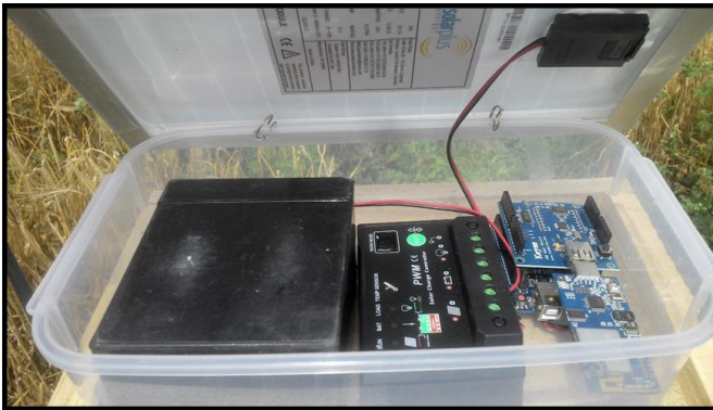
Fig.27 Componentes de un nodo sensor debidamente conectados
