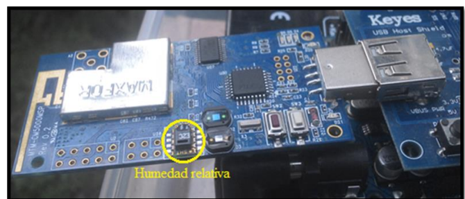
Fig.31 Identificación del sensor de humedad relativa en un nodo sensor instalado
