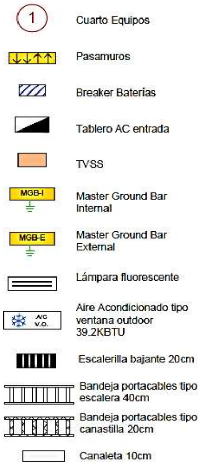
FIGURA 3.16: Normativa para descripción de equipos
